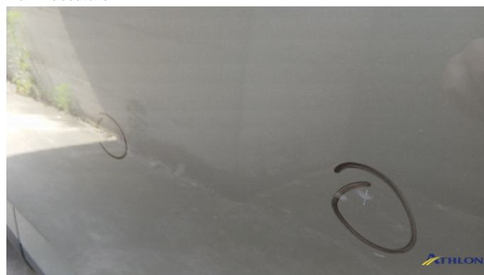
5. porta anteriore - destra 2 ammaccature
