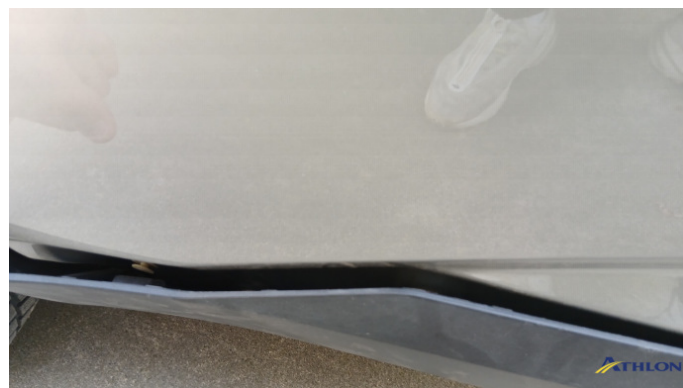
6. sottoporta - destra Rotto
