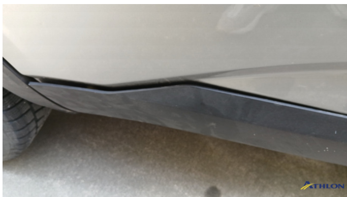
6. sottoporta - destra Rotto
