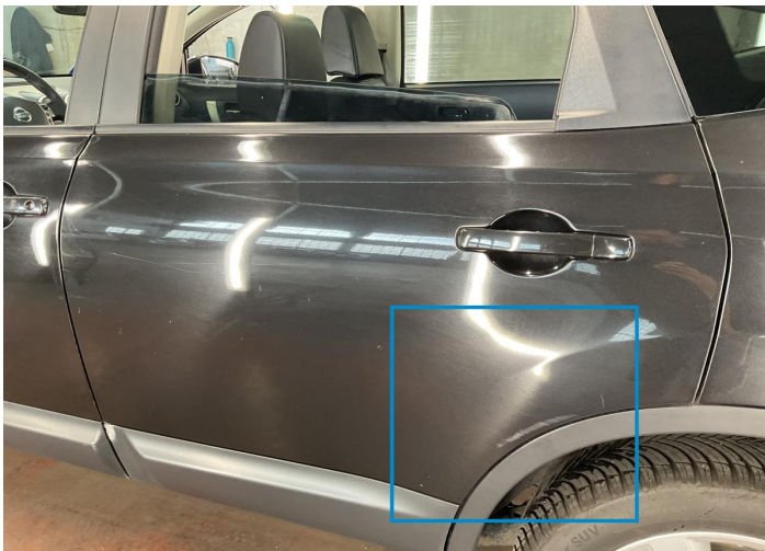
25. Door / Back Left Bodywork / Dent -
