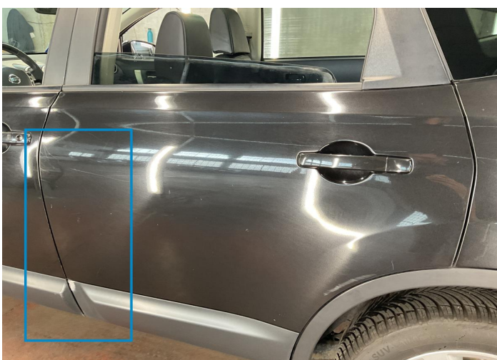
24. Door / Back Left Bodywork / Dent -
