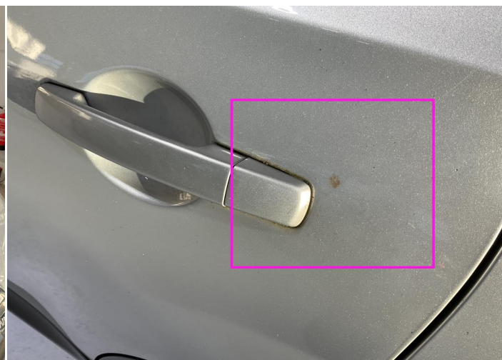
18. Door / Back Left Paint / Corrosion -
