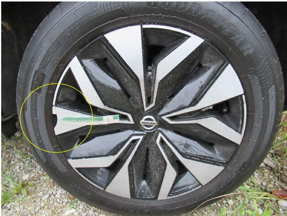
Bild 20 : Felge hinten links Radzierdeckel, zerbrochen, erneuern
