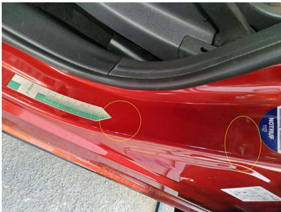
Bild 14 : Tür vorne links Einstieg, mehrfach eingedellt, instandsetzen und lackieren mit Lackaufbau
