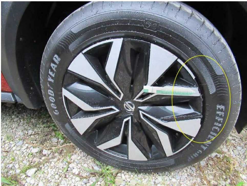
Bild 18 : Felge vorne rechts Radzierdeckel, zerbrochen, erneuern
