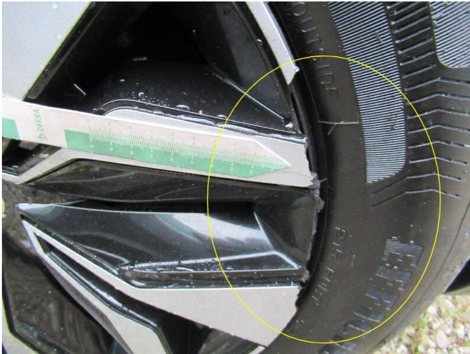
Bild 19 : Felge vorne rechts Radzierdeckel, zerbrochen, erneuern
