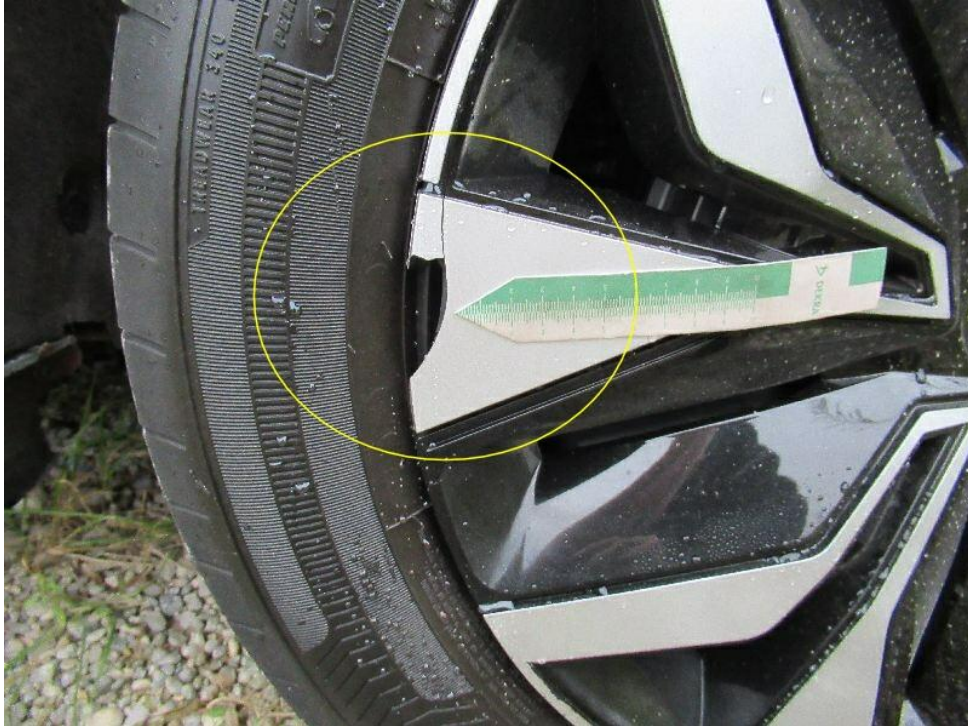
Bild 21 : Felge hinten links Radzierdeckel, zerbrochen, erneuern
