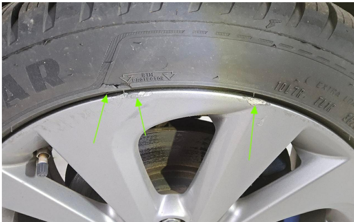
Bild 15 : Felge vorne rechts Materialabtrag
