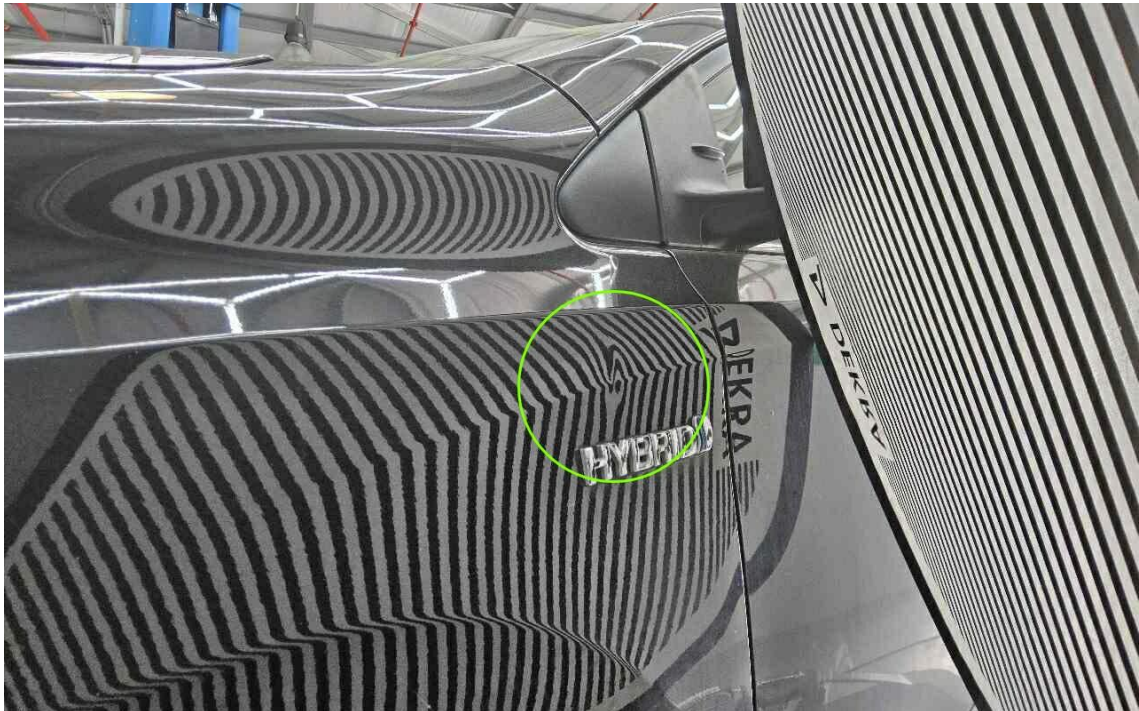
Bild 13 : Kotflügel vorne links mehrfach eingedellt
