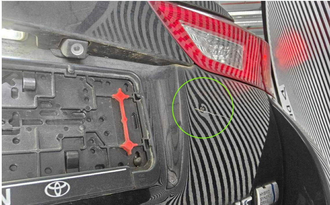
Bild 25 : Heckklappe eingedellt und zerkratzt
