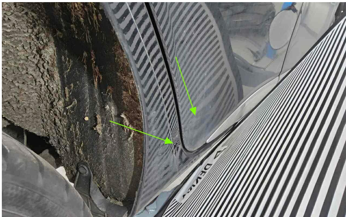
Bild 19 : Seitenwand hinten rechts deformiert
