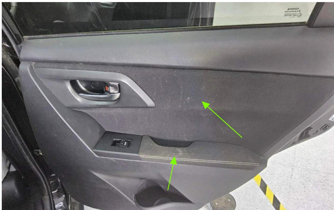
Bild 9 : Innenraum verschmutzt - Schimmelbefall
