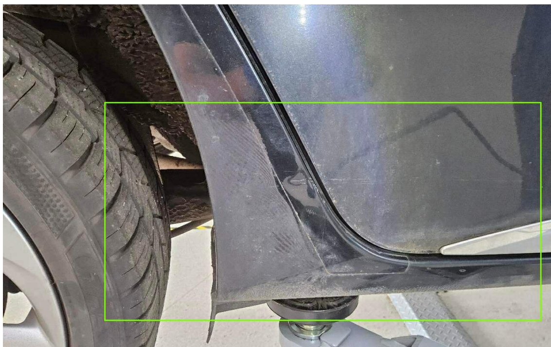
Bild 18 : Seitenwand hinten rechts deformiert
