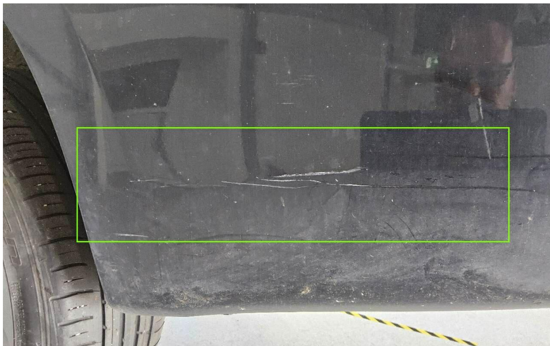
Bild 21 : Stoßfänger hinten zerkratzt
