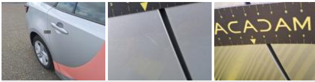
Door RR, Scratch(es), Acceptable
