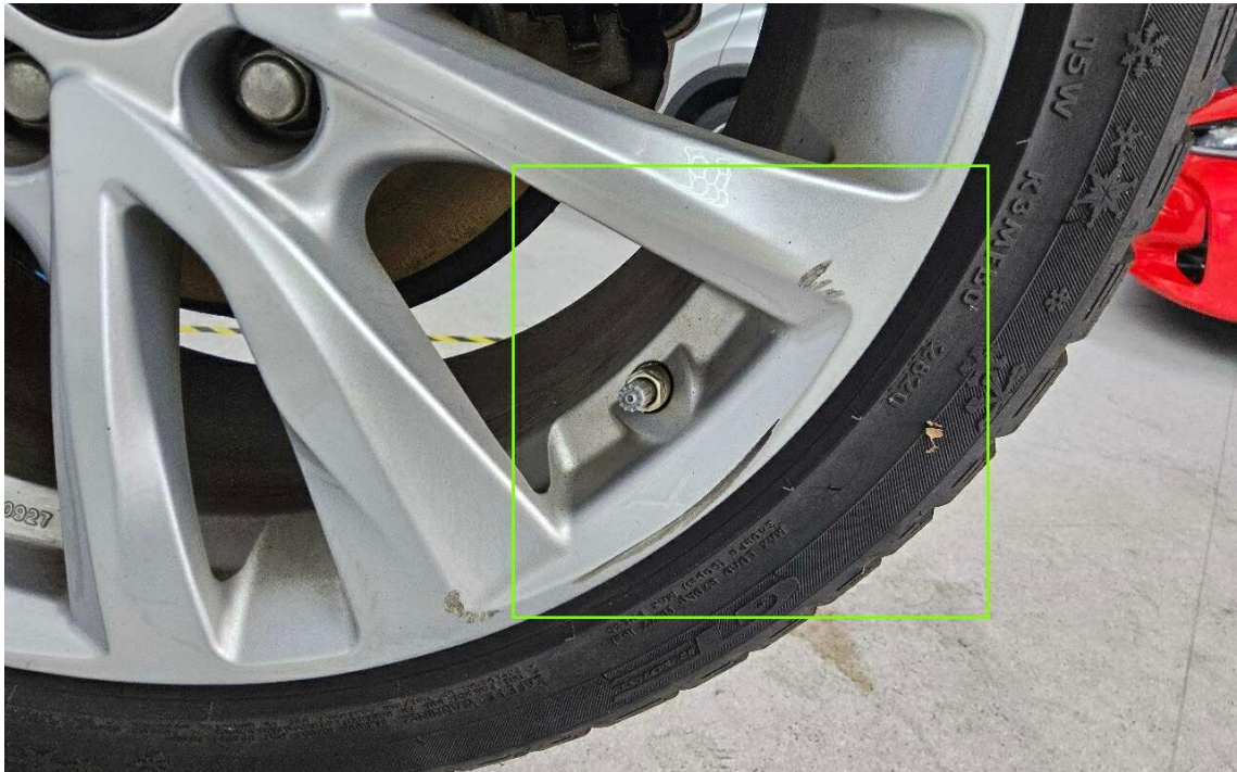
Bild 39 : Felge hinten links zerkratzt
