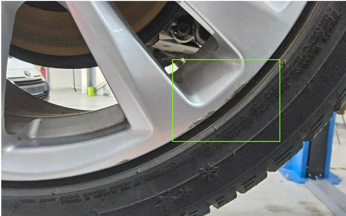
Bild 35 : Felge hinten rechts zerkratzt
