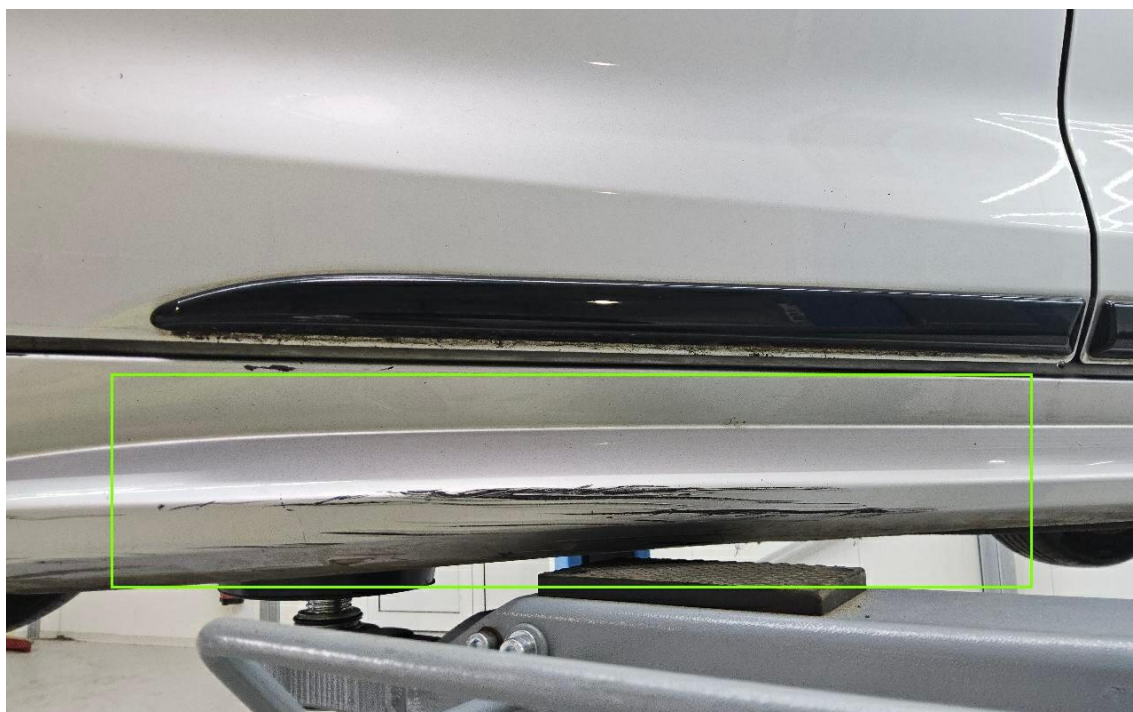
Bild 26 : Schwellerverkleidung rechts zerkratzt
