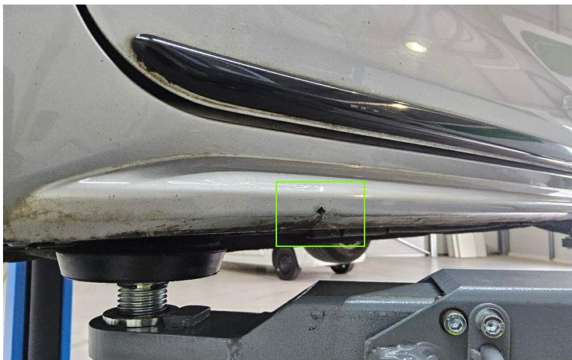
Bild 34 : Schwellerverkleidung links zerkratzt
