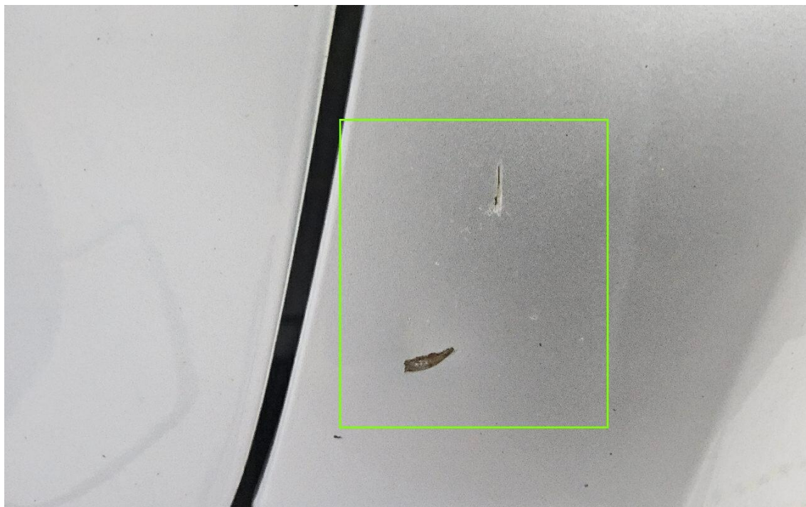
Bild 24 : Kotflügel vorne rechts eingedellt und zerkratzt
