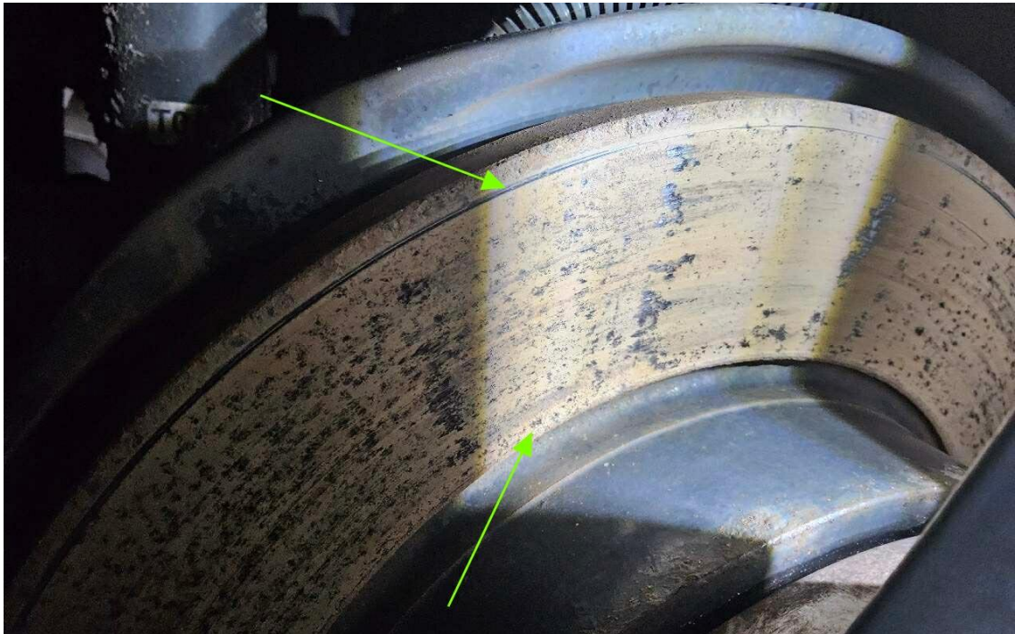
Bild 37 : starke Korrosionsbildung Bremse vorne und hinten
