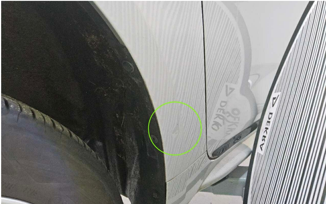
Bild 19 : Kotflügel vorne links eingedellt
