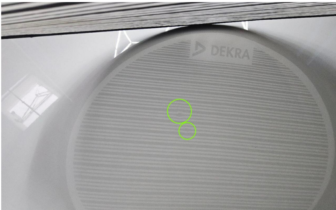
Bild 16 : Motorhaube mehrfach eingedellt
