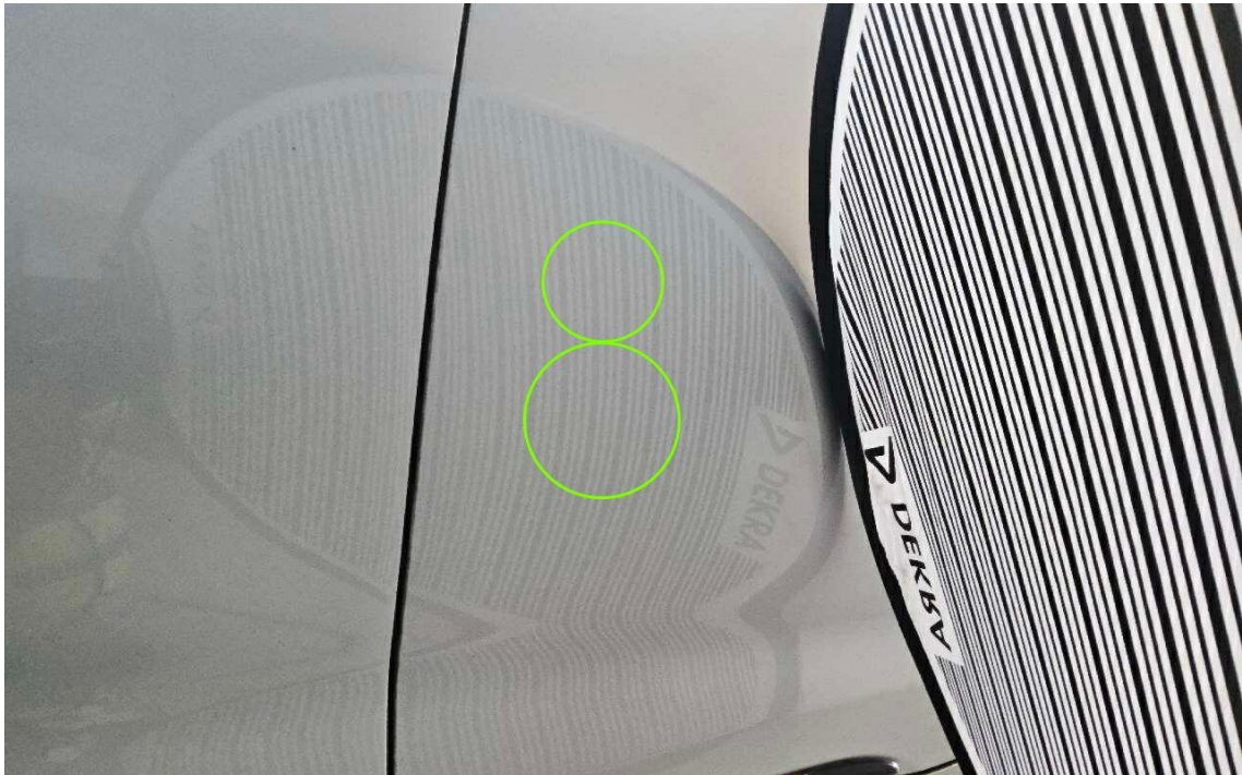
Bild 35 : Tür hinten links mehrfach eingedellt
