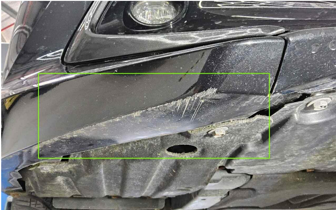
Bild 9 : Stoßfänger vorne unterhalb zerkratzt
