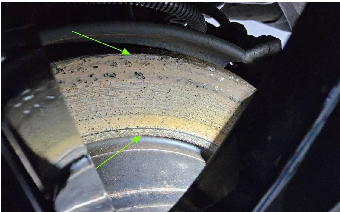
Bild 14 : starke Korrosionsbildung Bremse vorne und hinten
