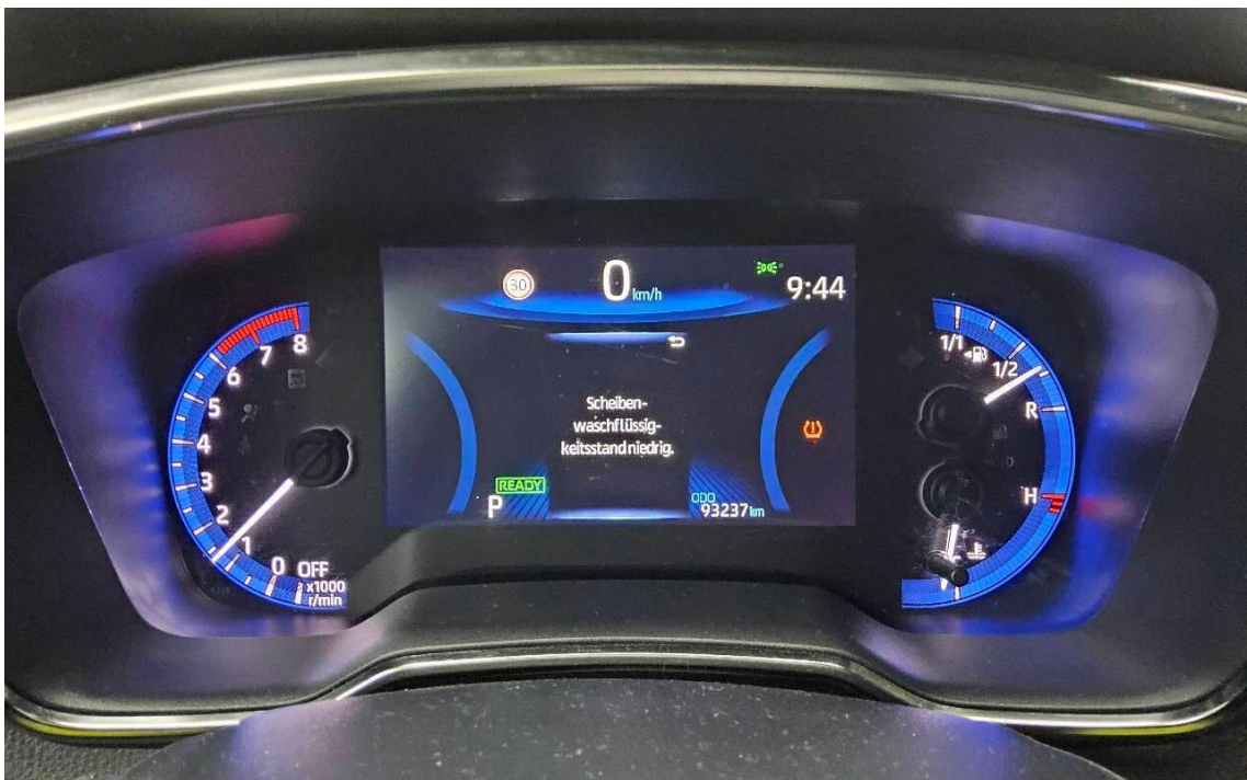
Bild 4 : Kombiinstrument (betriebsbereit) mit Km-Stand
