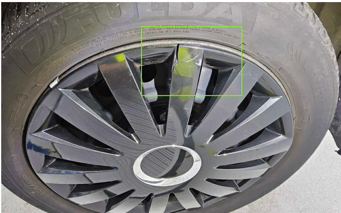
Bild 34 : Radzierblenden verschrammt/zerbrochen - Minderwert angesetzt
