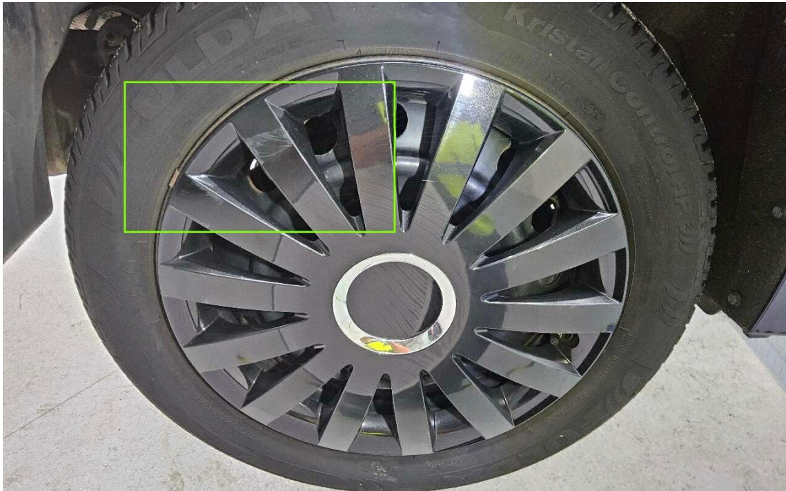
Bild 35 : Radzierblenden verschrammt/zerbrochen - Minderwert angesetzt
