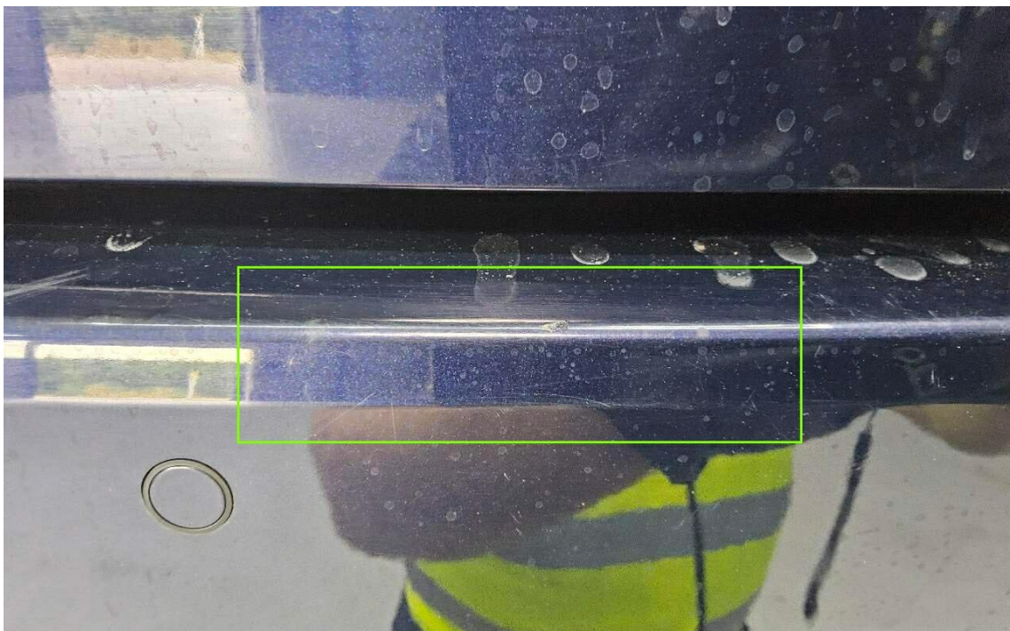
Bild 20 : Stoßfänger hinten rechts zerkratzt
