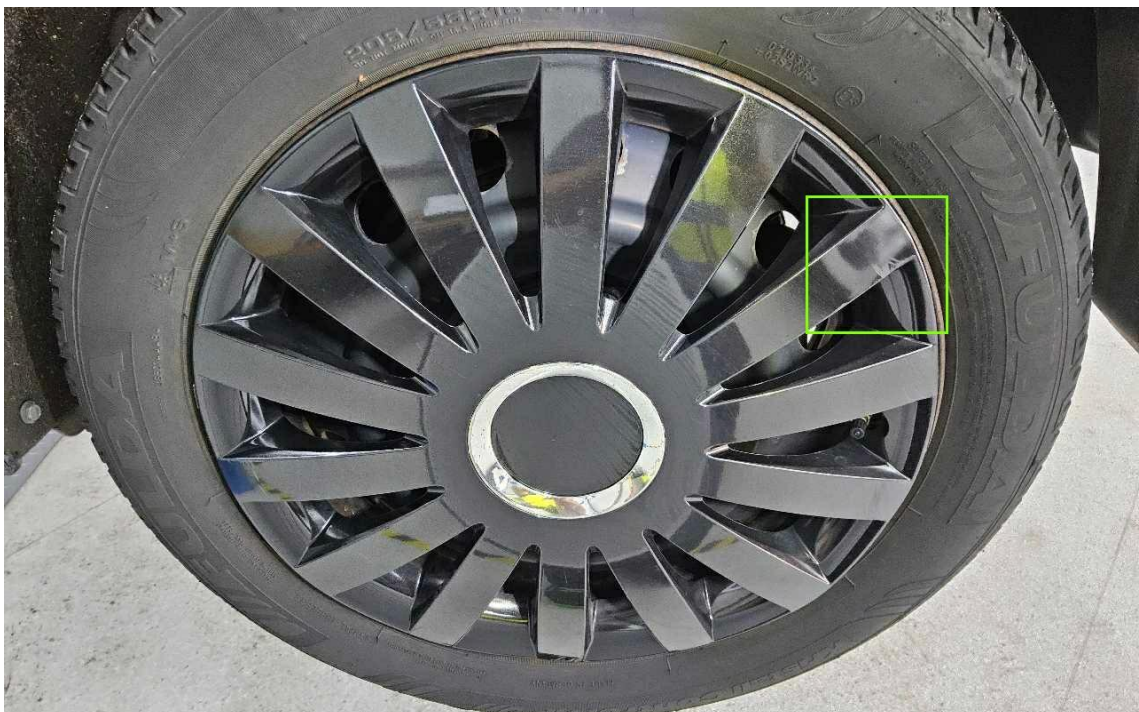
Bild 36 : Radzierblenden verschrammt/zerbrochen - Minderwert angesetzt
