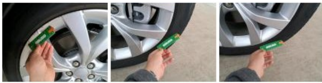
Pneu AVD, Déformé / Forcé, E - Remplacer
