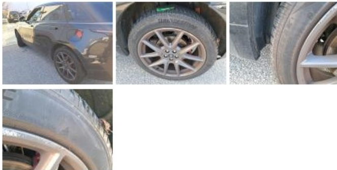
Reifen vorne links, Außerhalb Toleranzbereich, Ersetzen
