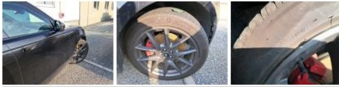
Reifen hinten rechts, Außerhalb Toleranzbereich, Ersetzen
