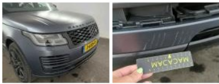
Bumper V spoiler, Gebroken, Herstellen en spuiten (compleet)
