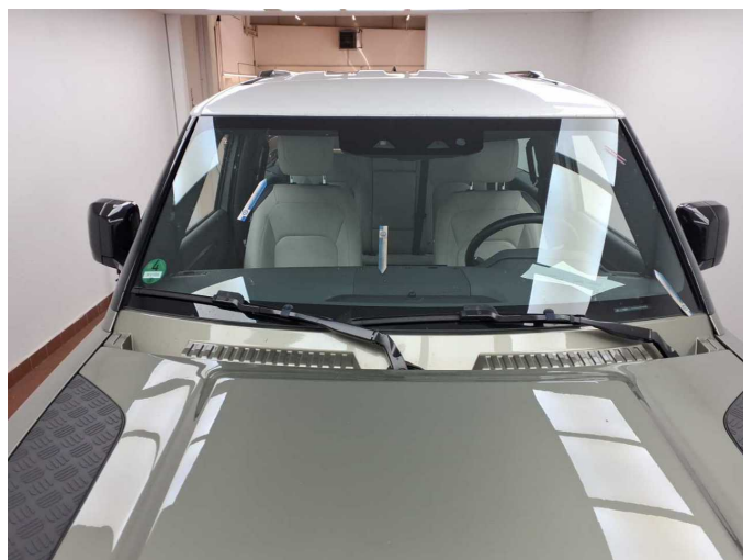
Beschädigung 7: Verglasung: Frontscheibe (mit Rissbildung) - Steinschlag - erneuern
