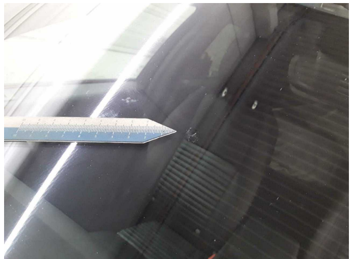
Damage 1: Vehicle glazing: Windscreen (Steinschlag wurde repariert) - Stone chips - No deduction
