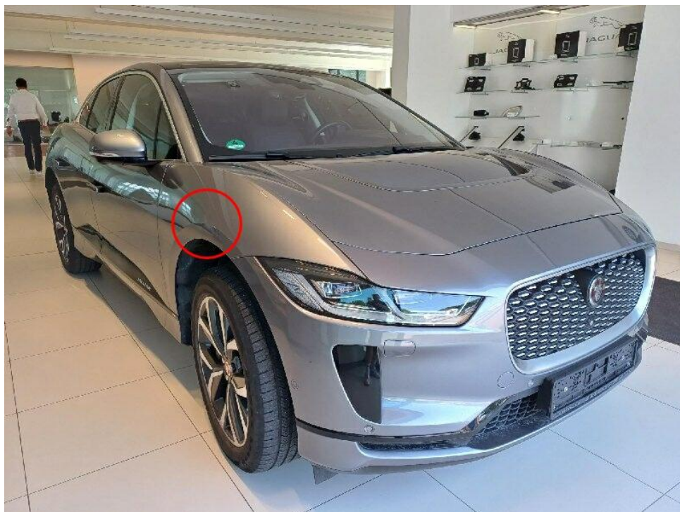
Bild 9 : Kotflügel vorne rechts, eingedellt, smart repair
