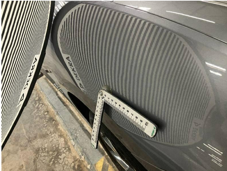
Bild 10 : Kotflügel vorne rechts, eingedellt, smart repair
