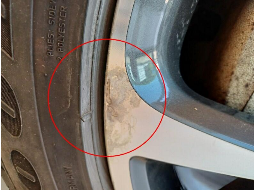
Bild 6 : Felge vorne rechts korrodiert
