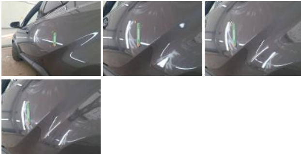
Spoiler AV, Déformé / Forcé, E - Remplacer
