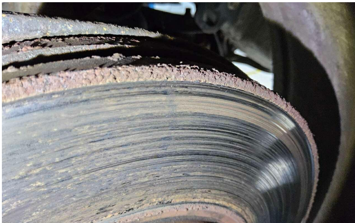
Bild 17 : Bremse stark korrodiert
