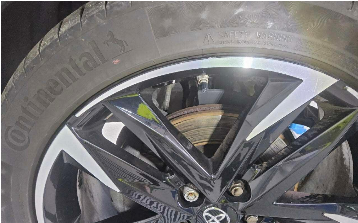
Bild 7 : Korrosionsbildung Bremse - Freibremsen erforderlich
