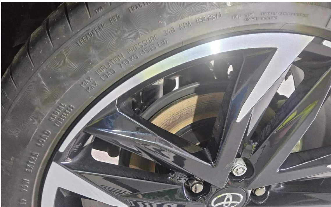
Bild 8 : Korrosionsbildung Bremse - Freibremsen erforderlich
