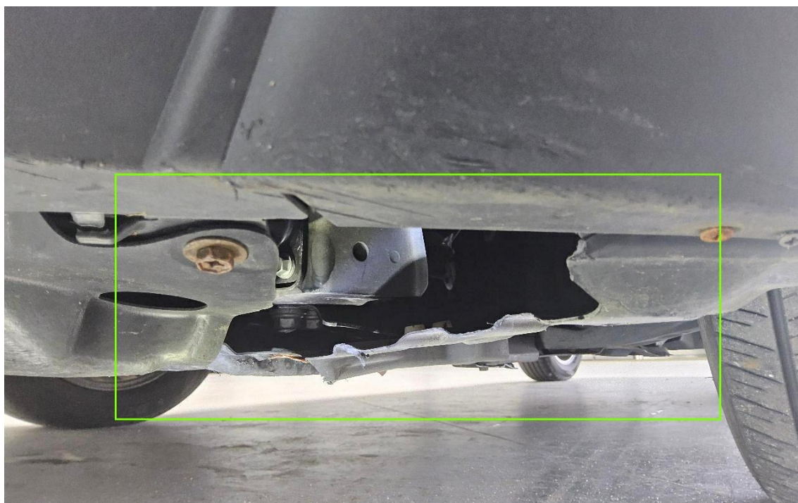
Bild 12 : Stoßfänger vorne beschädigt
