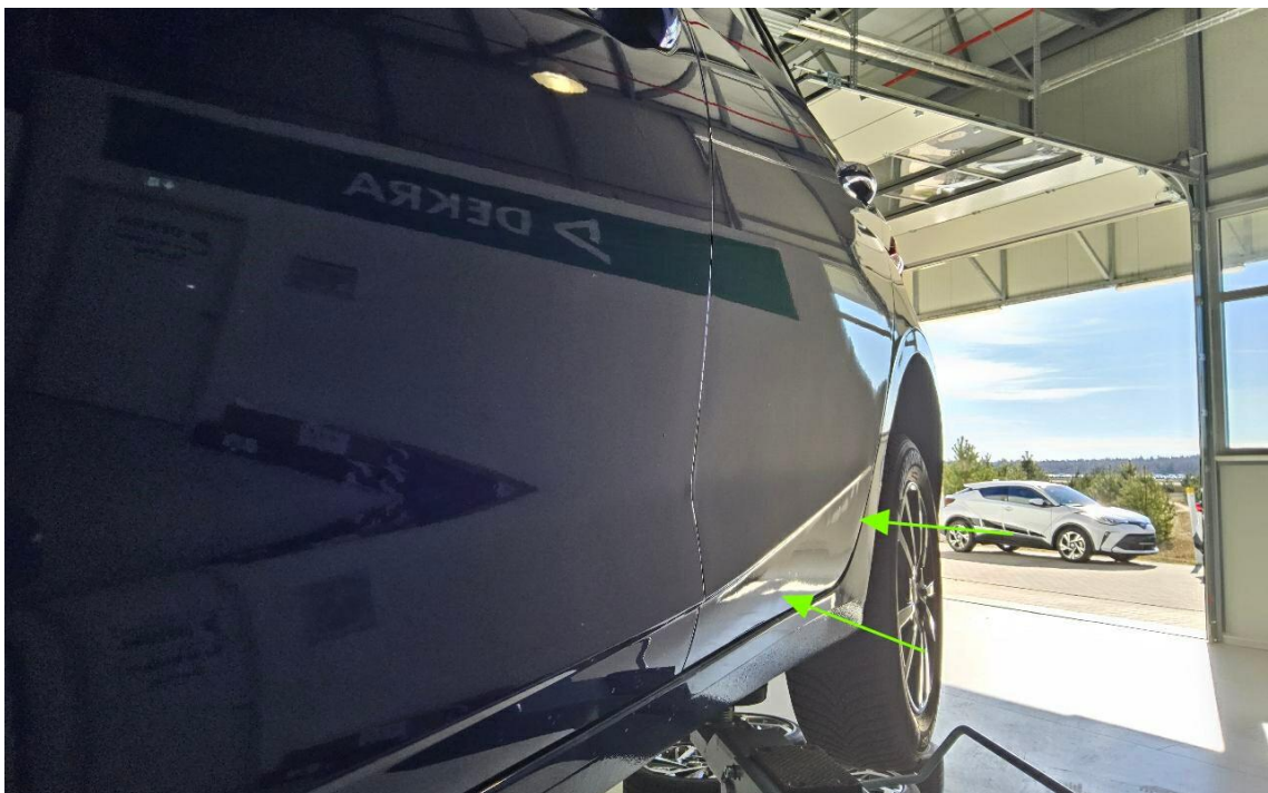
Bild 14 : Tür hinten links Korrosionsbildung - mangelhaft nachlackiert
