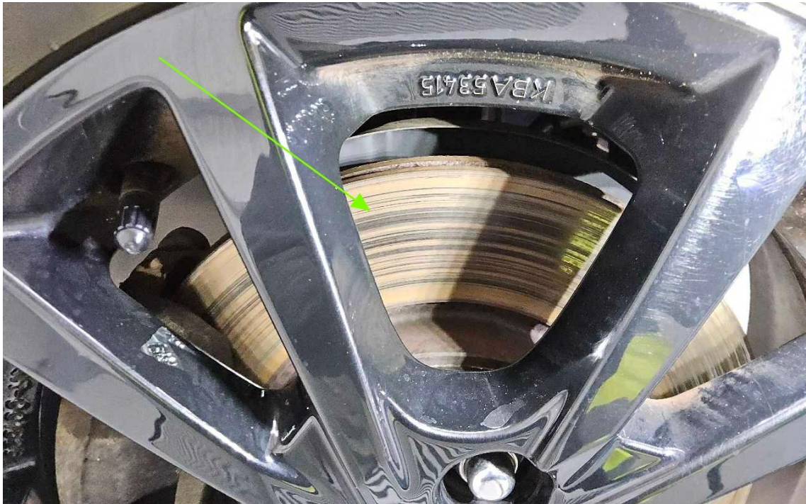
Bild 7 : Korrosionsbildung Bremse - Freibremsten erforderlich
