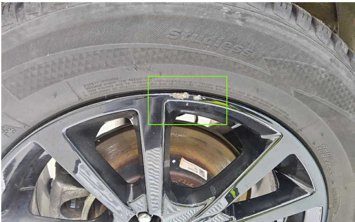
Bild 12 : Felge hinten rechts verschrammt - Minderwert angesetzt
