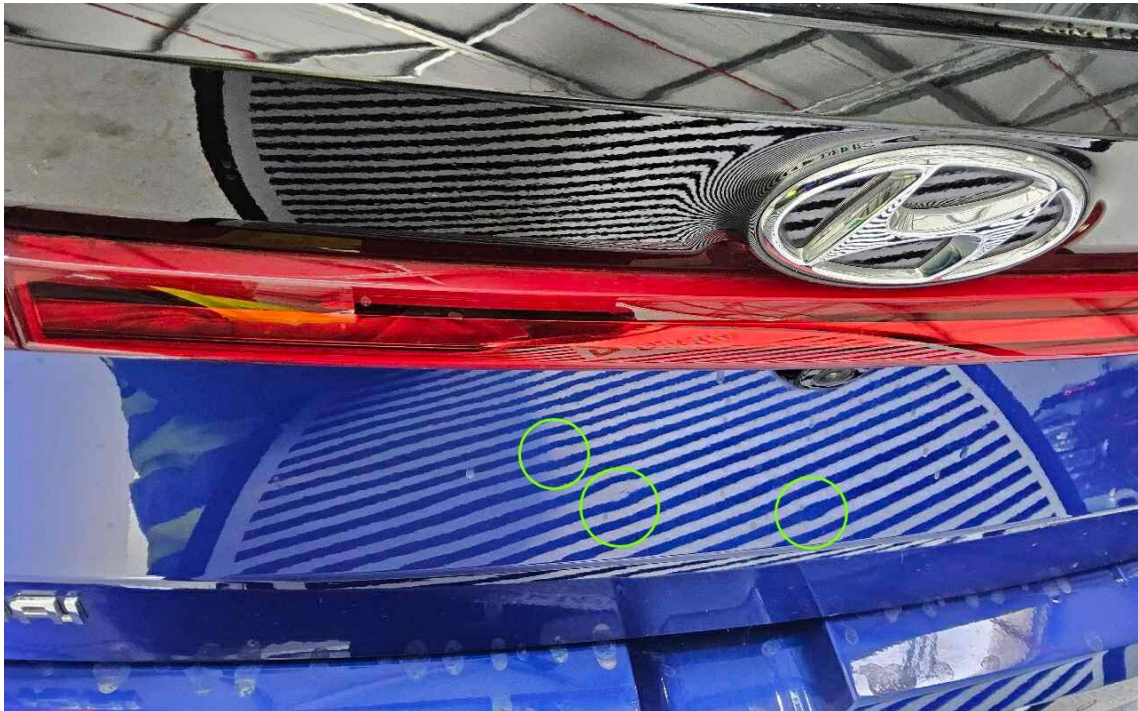
Bild 11 : Heckklappe mehrfach eingedellt
