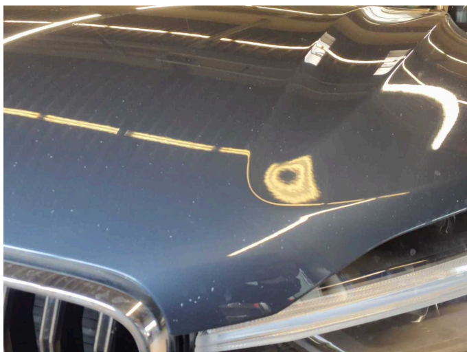
Damage 3: Bonnet: Bonnet (Sandstrahleffekt) - Scratch(es) - Paint
