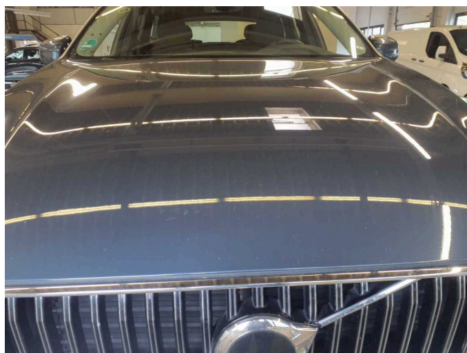
Damage 3: Bonnet: Bonnet (Sandstrahleffekt) - Scratch(es) - Paint
