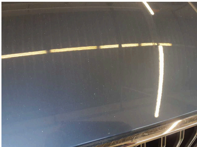
Damage 3: Bonnet: Bonnet (Sandstrahleffekt) - Scratch(es) - Paint
