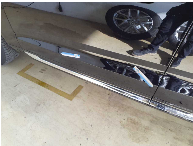
Damage 12: Door - front left side: Door - Scratch(es) - Paint
