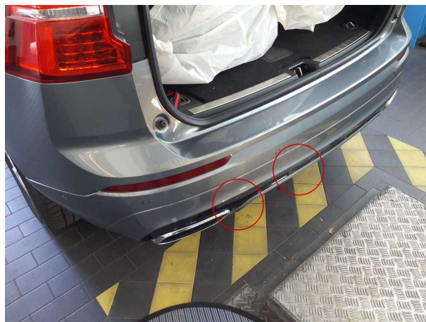
Beschädigung 5: Stossfänger hinten: Spoiler - verkratzt / verschürft - lackieren
