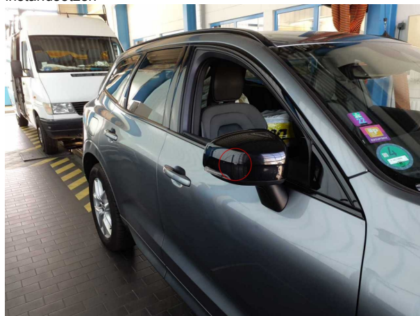
Beschädigung 4: Außenspiegel rechts: Abdeckkappe - verkratzt / verschürft - lackieren
