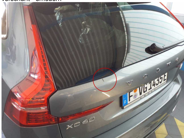
Beschädigung 12: Heckklappe/-tür: Heckklappe (starker Materialabtrag) - Kratzer - erneuern
