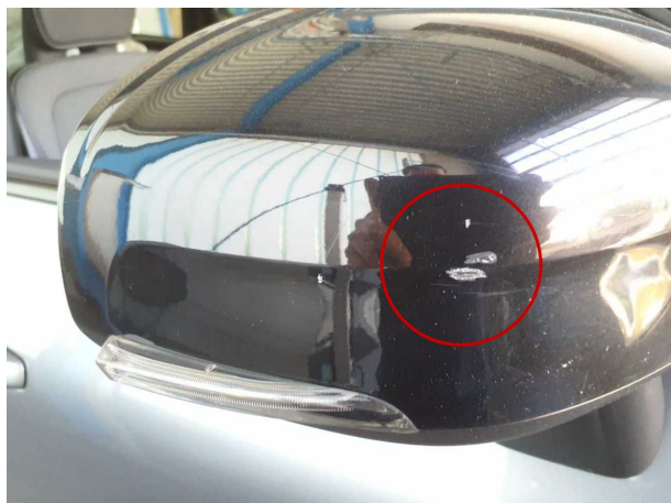
Beschädigung 4: Außenspiegel rechts: Abdeckkappe - verkratzt / verschürft - lackieren
