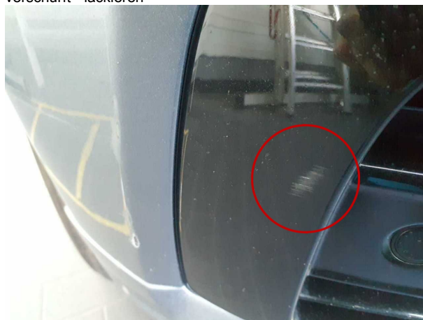
Beschädigung 6: Stossfänger vorn: Lufteinlassgitter (Rechts...) - verkratzt / verschürft - erneuern
