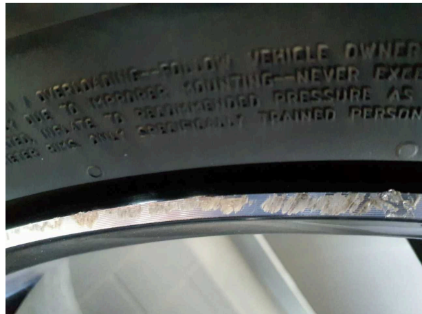
Beschädigung 10: 2.Radsatz: 1 Leichtmetallfelge (HL) - verkratzt / verschürft - erneuern
