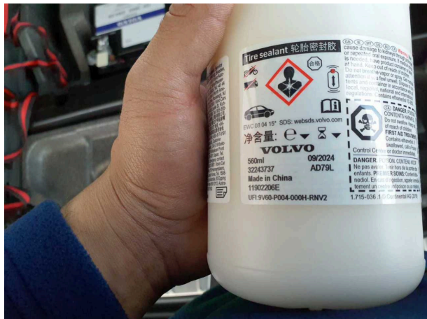
Beschädigung 1: Ausrüstung: Tirefit Füllmittel - abgelaufen - erneuern
