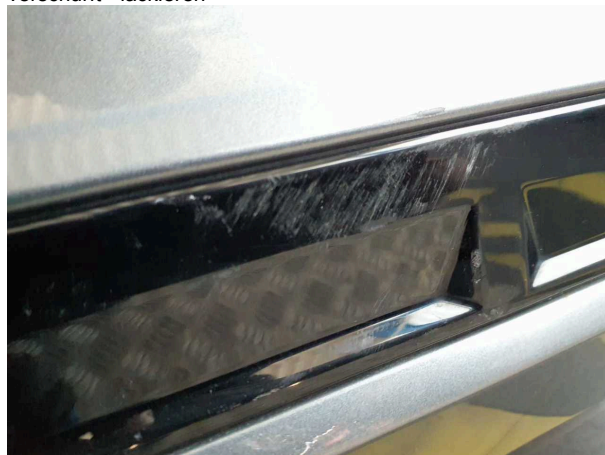
Beschädigung 5: Stossfänger hinten: Spoiler - verkratzt / verschürft - lackieren
