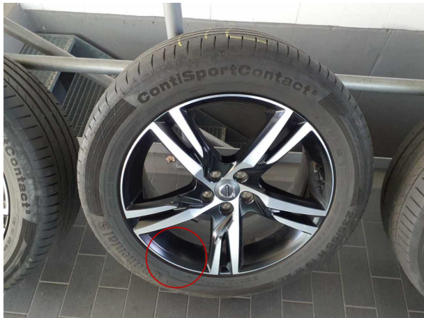
Beschädigung 10: 2.Radsatz: 1 Leichtmetallfelge (HL) - verkratzt / verschürft - erneuern
