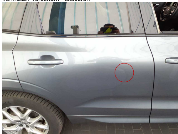
Beschädigung 8: Tür hinten rechts: Tür - Kratzer - lackieren
