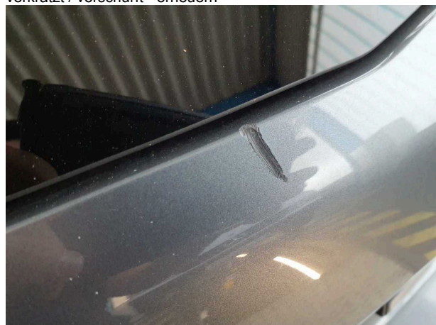
Beschädigung 12: Heckklappe/-tür: Heckklappe (starker Materialabtrag) - Kratzer - erneuern
