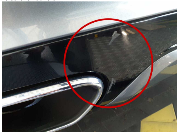
Beschädigung 5: Stossfänger hinten: Spoiler - verkratzt / verschürft - lackieren
