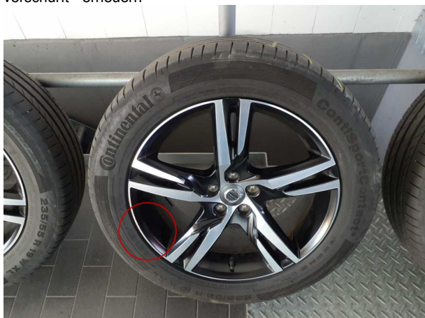
Beschädigung 11: 2.Radsatz: 1 Leichtmetallfelge (VR) - verkratzt / verschürft - erneuern
