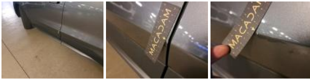
Door RR, Scratch(es), Acceptable
