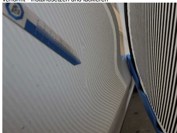
Beschädigung 5: Tür vorn links: Tür - verformt - instandsetz... und lackieren
