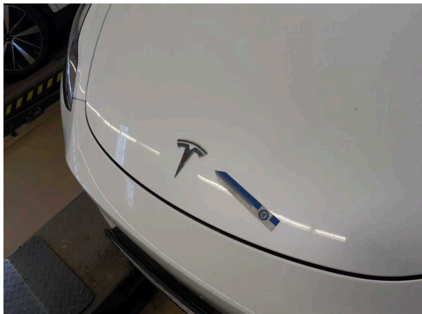
Beschädigung 1: Motorhaube: Motorhaube - Delle(n) - Smart Repair
