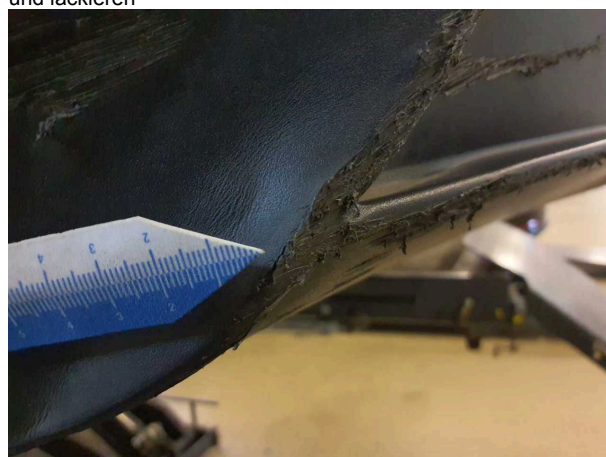
Beschädigung 6: Stossfänger hinten: Spoiler - verkratzt / verschürft - Wertminderung
