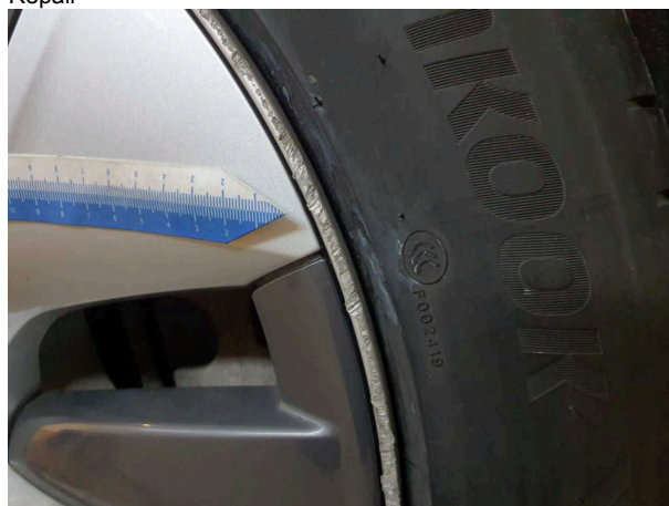
Beschädigung 2: Rad/Reifen: Leichtmetallfelge hinten links - verkratzt / verschürft - Smart Repair
