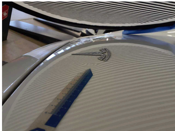
Beschädigung 1: Motorhaube: Motorhaube - Delle(n) - Smart Repair
