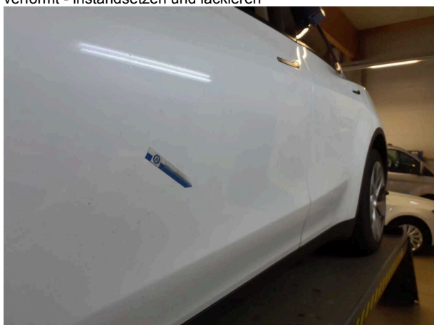
Beschädigung 5: Tür vorn links: Tür - verformt - instandsetzen u... lackieren
