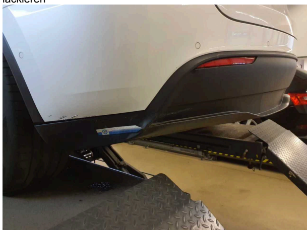
Beschädigung 6: Stossfänger hinten: Spoiler - verkratzt / verschürft - Wertminderung
