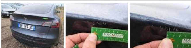
Joint de coffre, Dégrafé, N - Dépose/Répose
