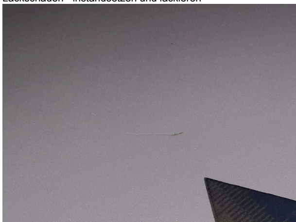
Beschädigung 2: Kotflügel rechts: Kotflügel rechts - Delle / Lackschaden - instandsetzen und lackieren
