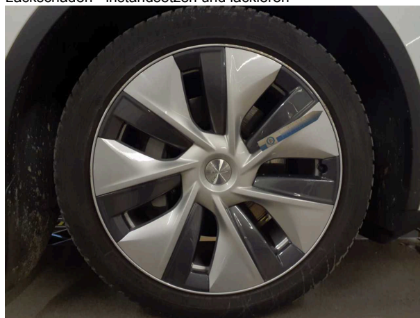
Beschädigung 3: Rad/Reifen: Leichtmetallfelge vorn rechts (Material Abtrag) - verkratzt / verschürft - erneuern
