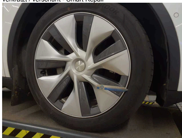
Beschädigung 8: Rad/Reifen: Reifen vorn rechts - gebroche... gerissen - erneuern
