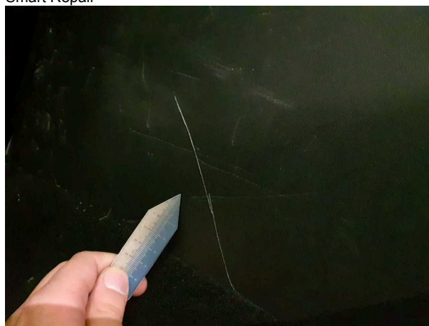
Beschädigung 3: Verkleidungen/Abdeckungen: Kofferraumverkleidung - verkratzt / verschürft - Smart Repair
