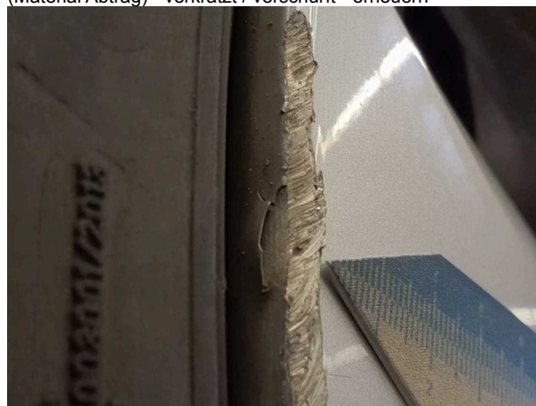
Beschädigung 11: Rad/Reifen: Leichtmetallfelge hinten rechts (Material Abtrag) - verkratzt / verschürft - erneuern
