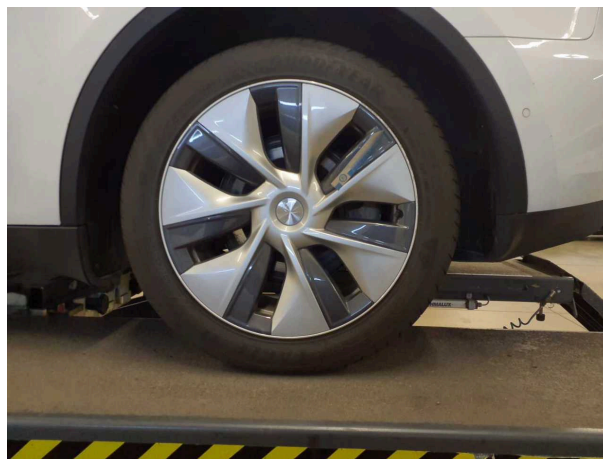
Beschädigung 7: Rad/Reifen: Leichtmetallfelge hinten links - verkratzt / verschürft - Smart Repair
