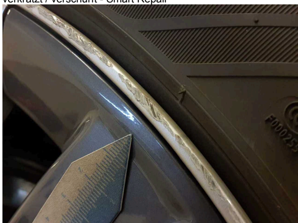
Beschädigung 7: Rad/Reifen: Leichtmetallfelge hinten links - verkratzt / verschürft - Smart Repair
