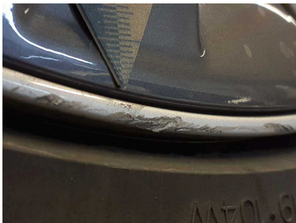
Beschädigung 6: Rad/Reifen: Leichtmetallfelge vorn links - verkratzt / verschürft - Smart Repair
