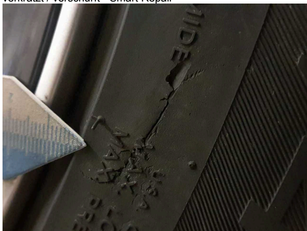
Beschädigung 8: Rad/Reifen: Reifen vorn rechts - gebrochen / gerissen - erneuern
