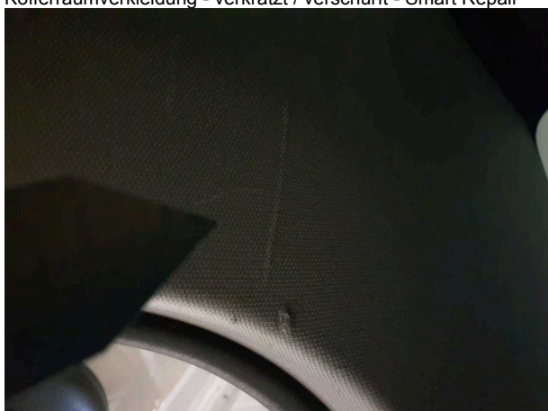
Beschädigung 4: Verkleidungen/Abdeckungen: Dachhimmel - verkratzt / verschürft - Smart Repair
