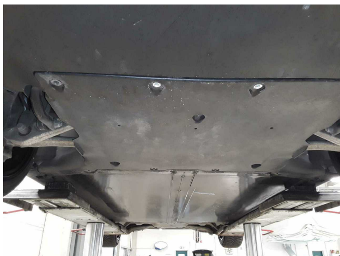
Gebrauchsspur 12: Karosserie: Unterbodenverkleidung - Kratzer - kein Abzug
