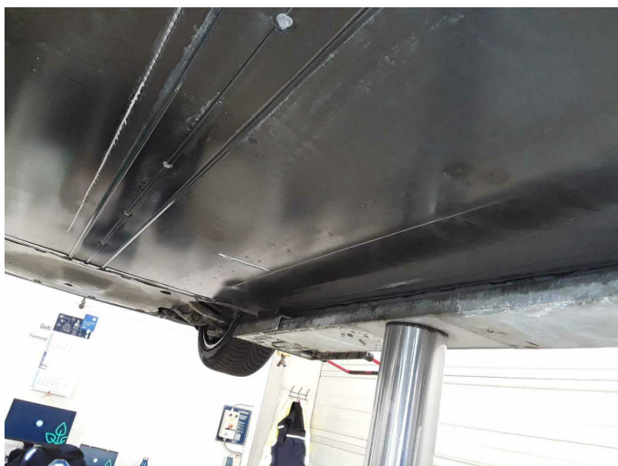
Gebrauchsspur 12: Karosserie: Unterbodenverkleidung - Kratzer - kein Abzug
