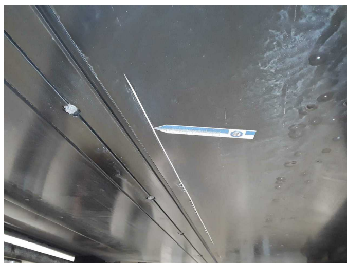
Gebrauchsspur 12: Karosserie: Unterbodenverkleidung - Kratzer - kein Abzug
