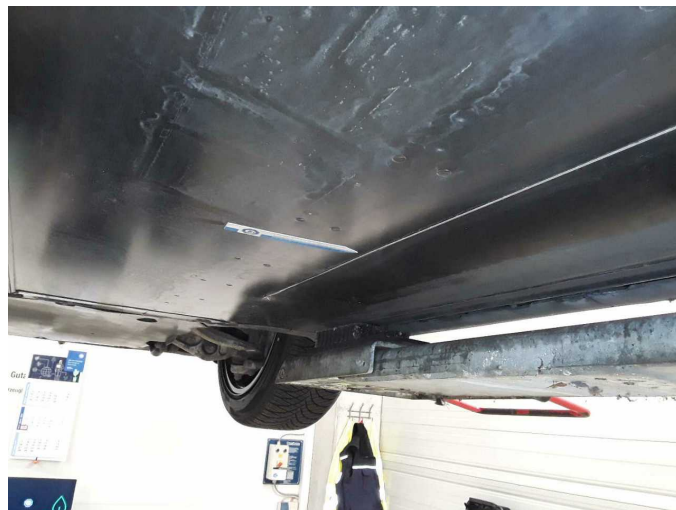
Gebrauchsspur 12: Karosserie: Unterbodenverkleidung - Kratzer - kein Abzug
