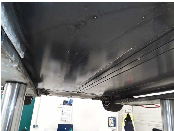
Gebrauchsspur 12: Karosserie: Unterbodenverkleidung - Kratzer - kein Abzug
