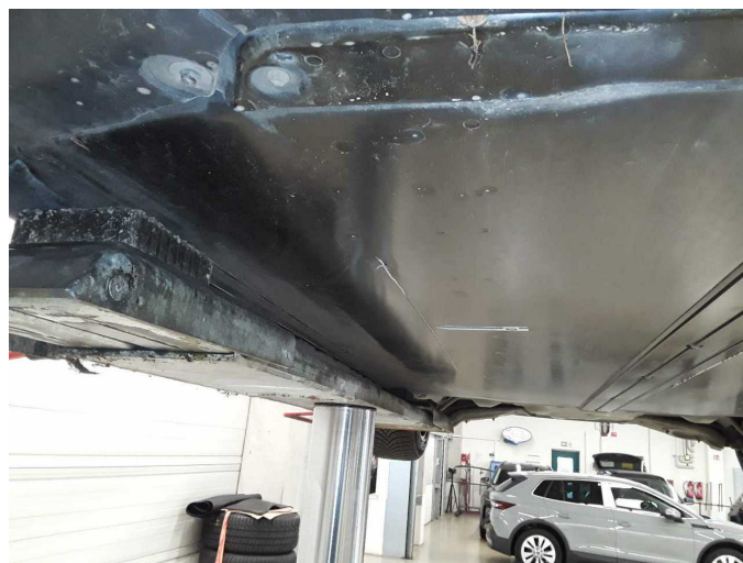
Gebrauchsspur 12: Karosserie: Unterbodenverkleidung - Kratzer - kein Abzug
