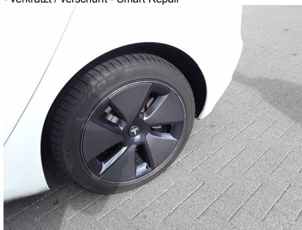
Beschädigung #7: Rad/Reifen: Leichtmetallfelge hinten links (Materialabrieb) - verkratzt / verschürft - erneuern
