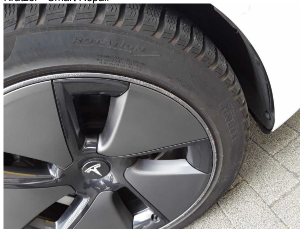
Beschädigung #2: Rad/Reifen: Leichtmetallfelge vorn rechts - verkratzt / verschürft - Smart Repair
