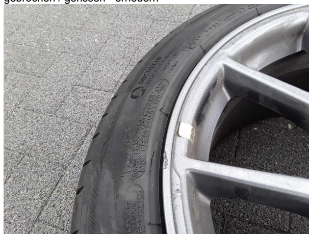
Beschädigung #5: 2.Radsatz: 1 Reifen - gebrochen / gerissen - erneuern
