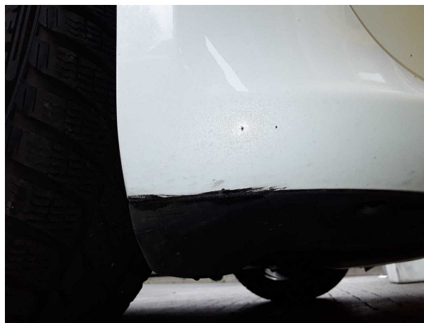
Beschädigung #1: Stossfänger vorn: Stossfänger vorn - Kratzer - Smart Repair
