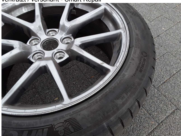
Beschädigung #6: 2.Radsatz: Leichtmetallfelgensatz komplett - verkratzt / verschürft - Smart Repair
