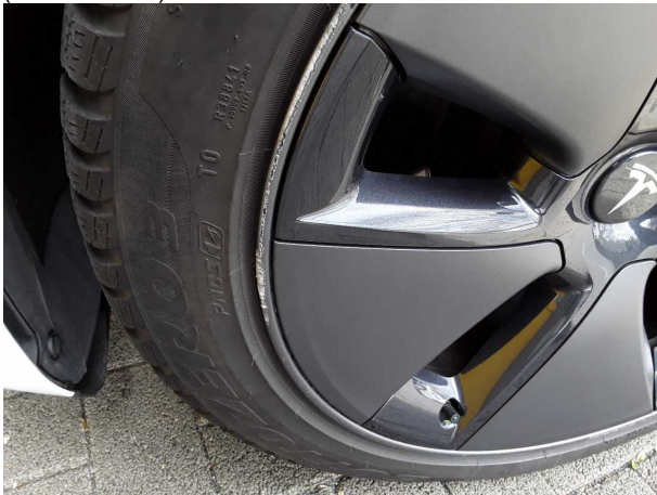
Beschädigung #9: Rad/Reifen: Leichtmetallfelge vorn links (Materialabrieb) - verkratzt / verschürft - erneuern
