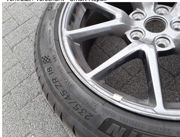
Beschädigung #6: 2.Radsatz: Leichtmetallfelgensatz komplett - verkratzt / verschürft - Smart Repair
