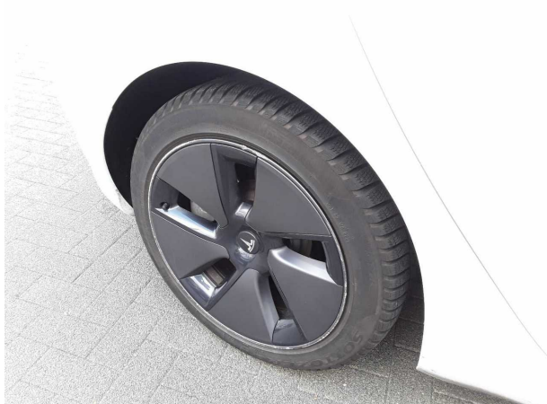
Beschädigung #8: Rad/Reifen: Leichtmetallfelge hinten rechts (Materialabrieb) - verkratzt / verschürft - erneuern
