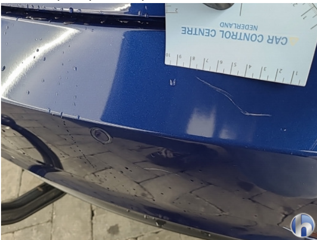
1. Achterbumper Krassen - Spot Repair/Deelreparatie
