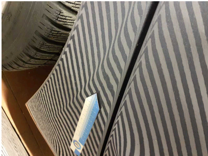
Beschädigung 1: Seitenwand rechts: Seitenwand - Delle(n) - Smart Repair
