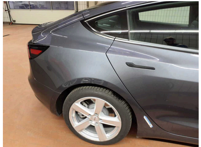
Beschädigung 1: Seitenwand rechts: Seitenwand - Delle(n) - Smart Repair
