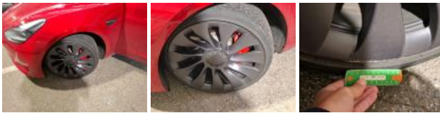
Alloy rim RL, Scratch(es), Repair/replace (lump sum)
