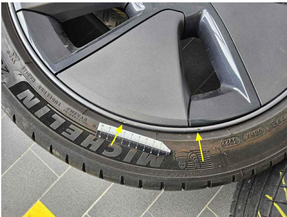
Bild 35 : Schadendetail, Original LM-Felge 2, verschrammt
