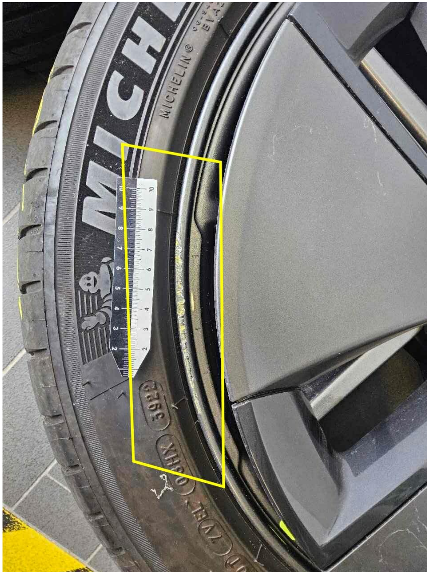
Bild 33 : Schadendetail, Original LM-Felge 1, verschrammt
