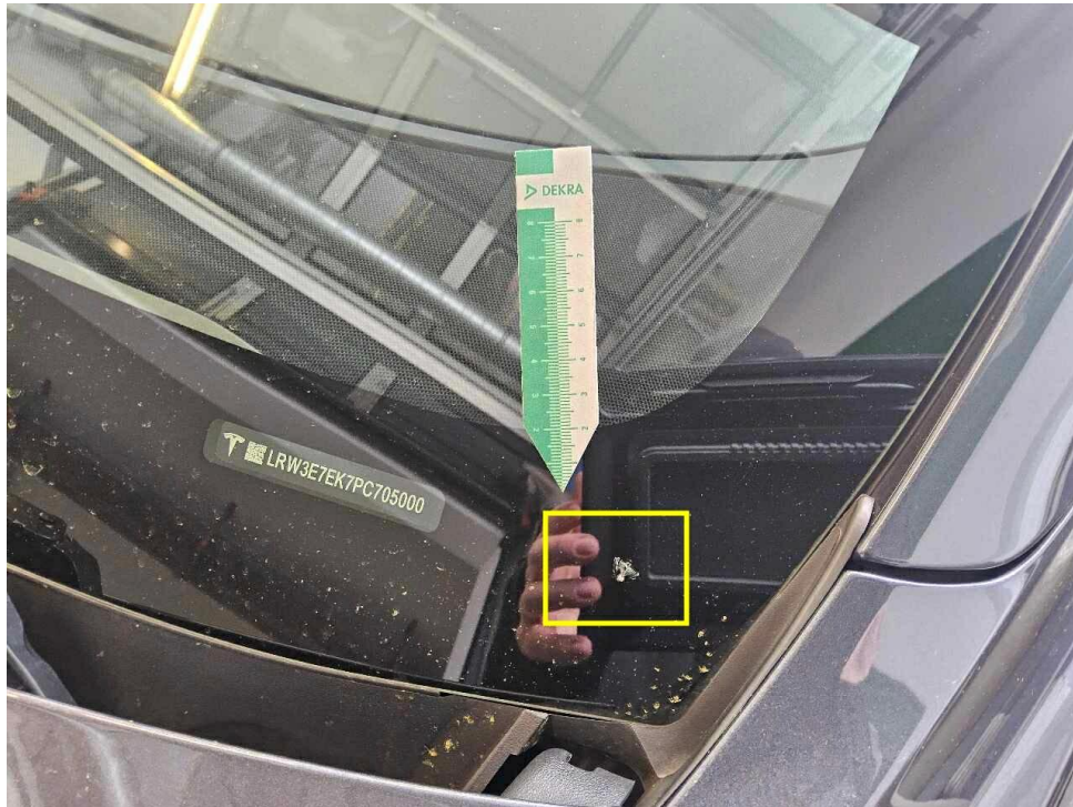
Bild 21 : Schadendetail, Windschutzscheibe, Steinschlag
