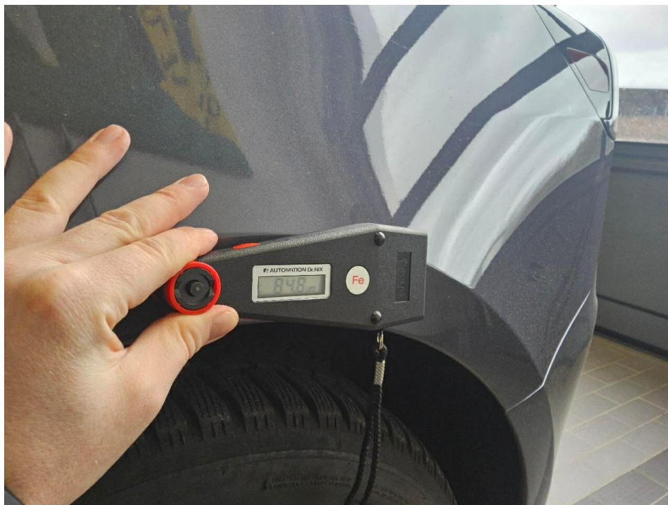
Bild 45 : Seitenwand hinten links, Lackschichtdicke 848 \mu m
