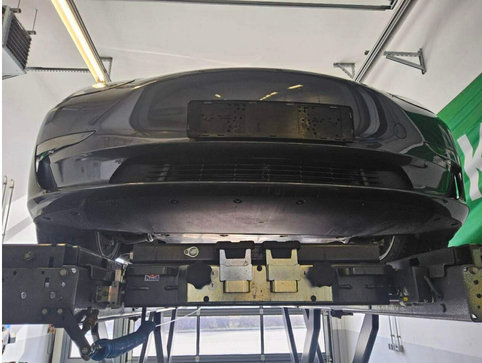
Bild 15 : Schadenübersicht, Frontspoiler Lackierung, verschrammt, lackieren mit Lackaufbau
