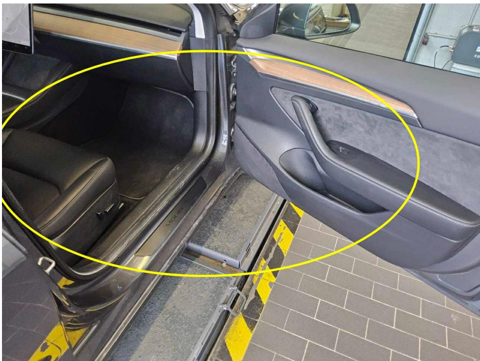
Bild 39 : Verkleidung Tür vorne rechts, zerkratzt, Gebrauchsspur Einstiegsblende vorne rechts, zerkratzt, Gebrauchsspur
