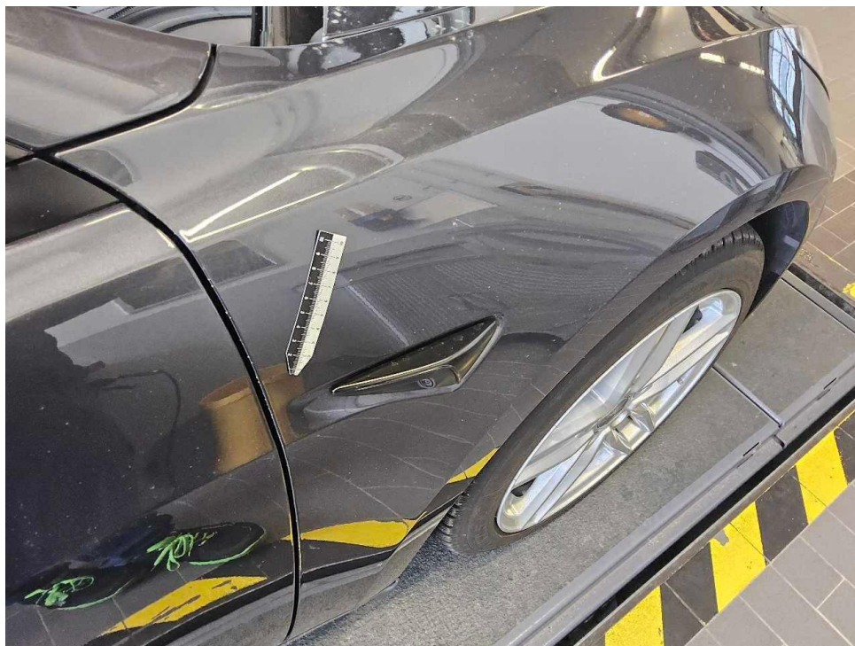
Bild 36 : Schadenübersicht, Kotflügel vorne rechts Lackierung, zerkratzt, Gebrauchsspur
