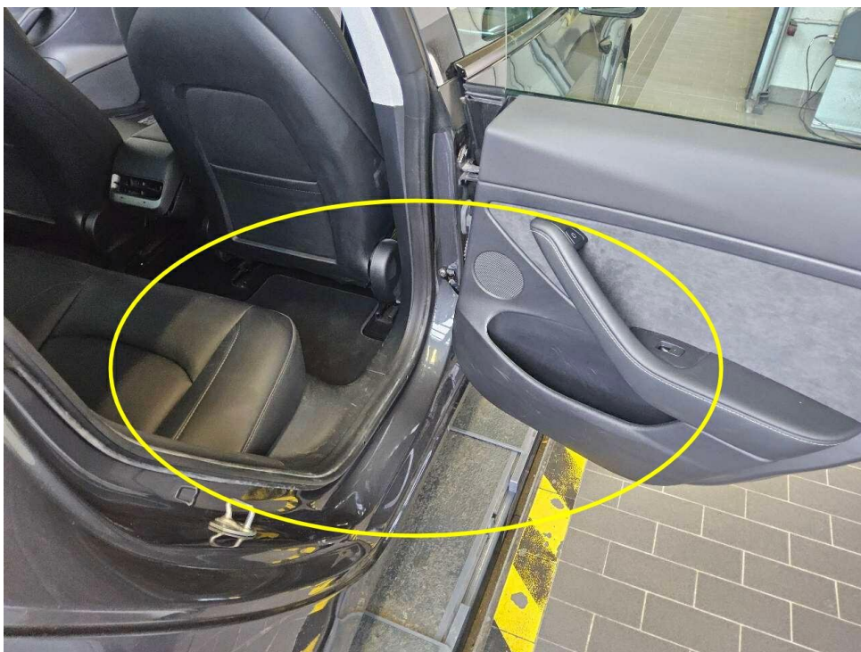
Bild 41 : Verkleidung Tür hinten rechts, zerkratzt, Gebrauchsspur Einstiegsblende hinten rechts, zerkratzt, Gebrauchsspur
