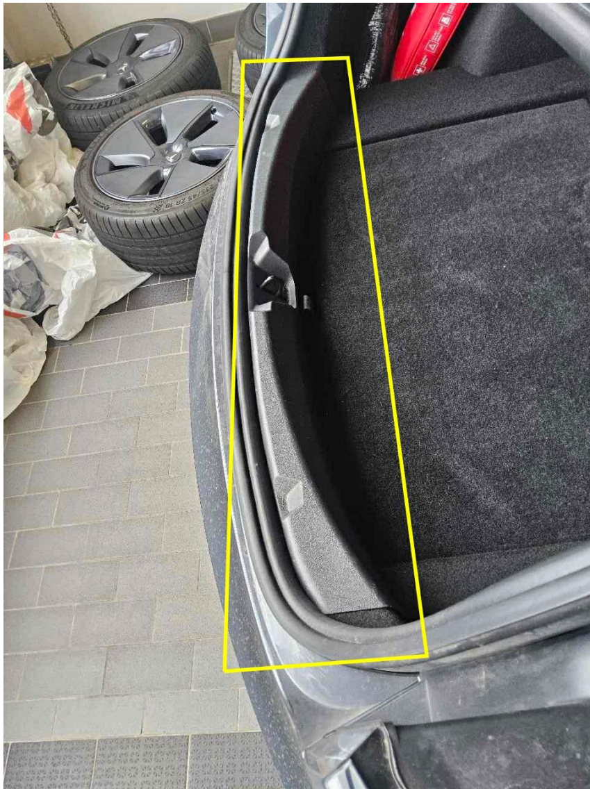
Bild 42 : Ladekantenabdeckung, zerkratzt, Gebrauchsspur
