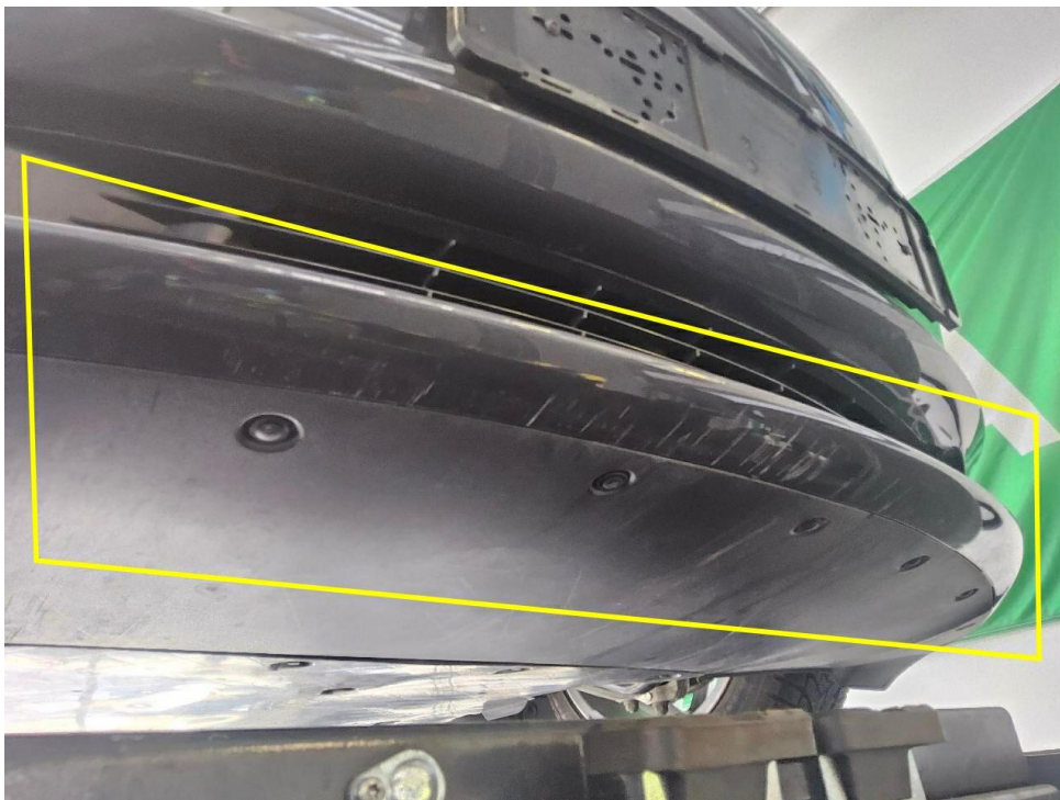
Bild 16 : Schadendetail, Frontspoiler Lackierung, verschrammt, lackieren mit Lackaufbau
