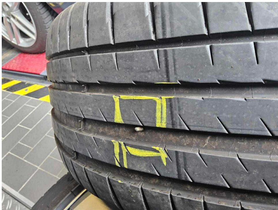
Bild 31 : Schadendetail Schraube im Sommerreifen
