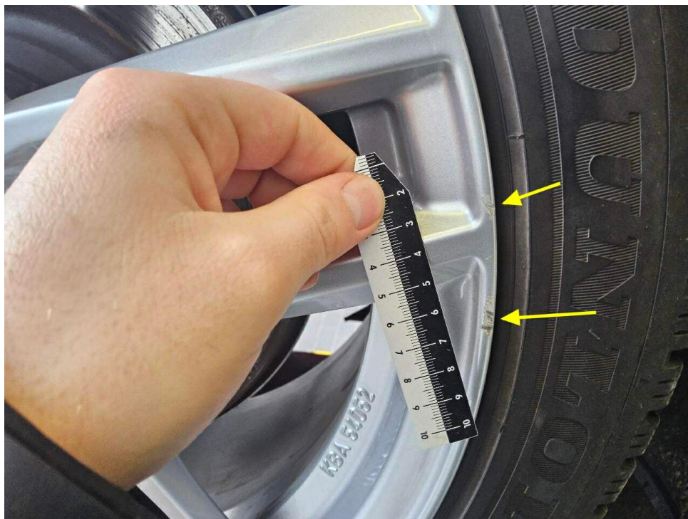
Bild 29 : Schadendetail, LM Zubehörfelge hinten rechts, verschrammt
