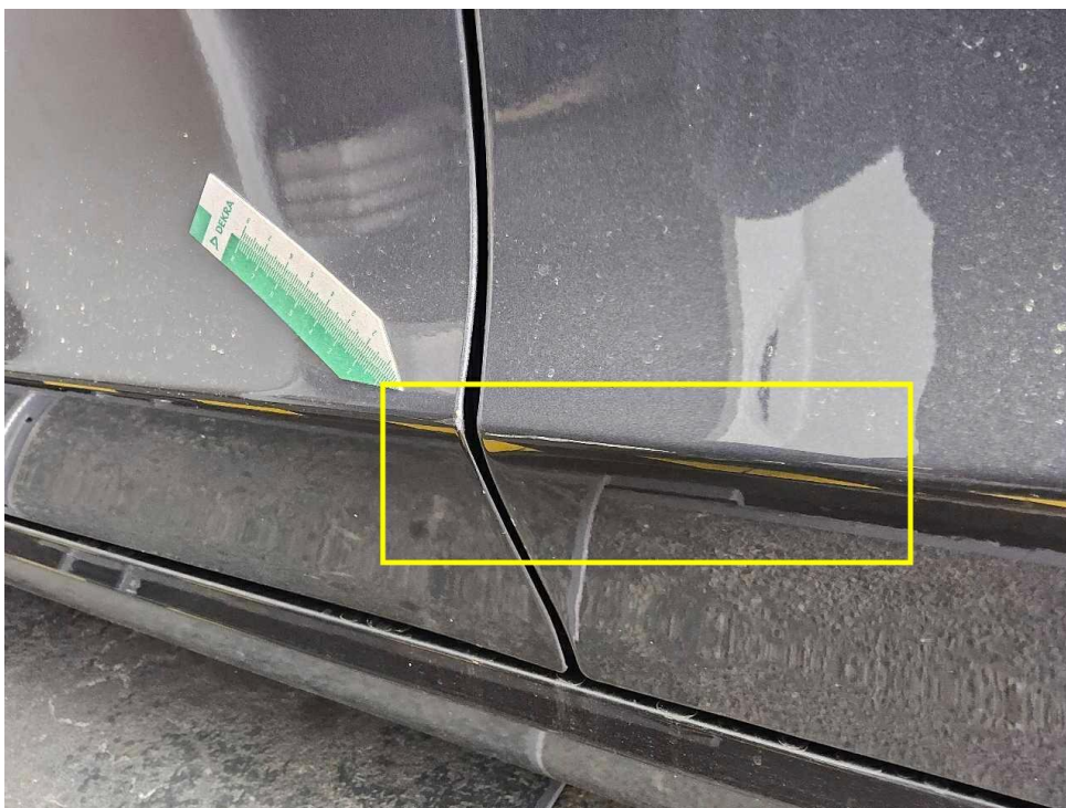
Bild 24 : Schadendetail, Tür hinten links Lackierung, zerkratzt, smart repair
