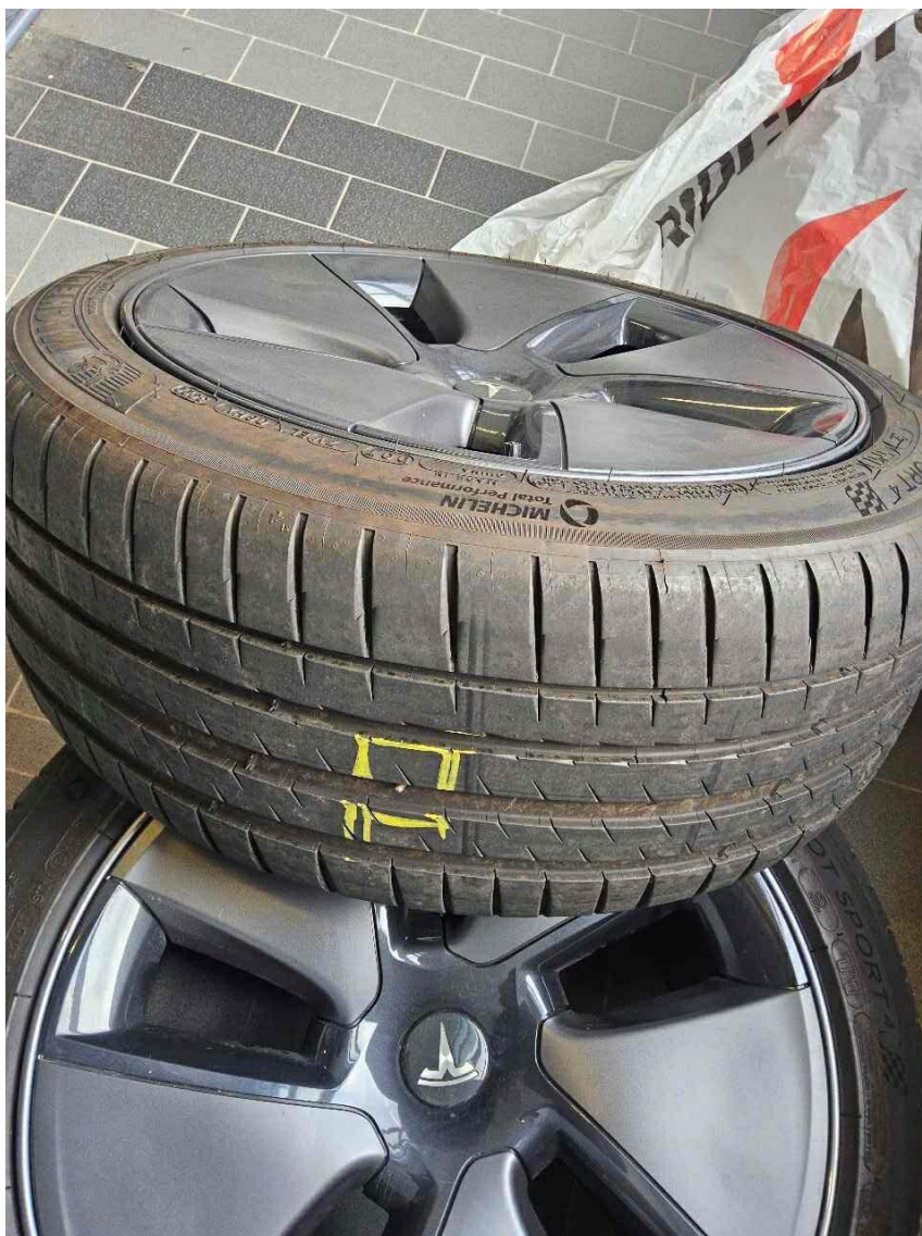
Bild 30 : Schadenübersicht, Schraube im Sommerreifen
