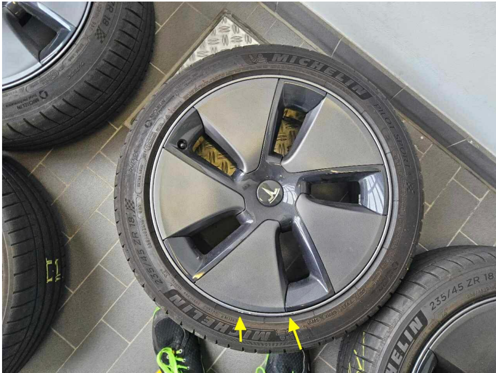
Bild 34 : Schadenübersicht, Original LM-Felge 2, verschrammt
