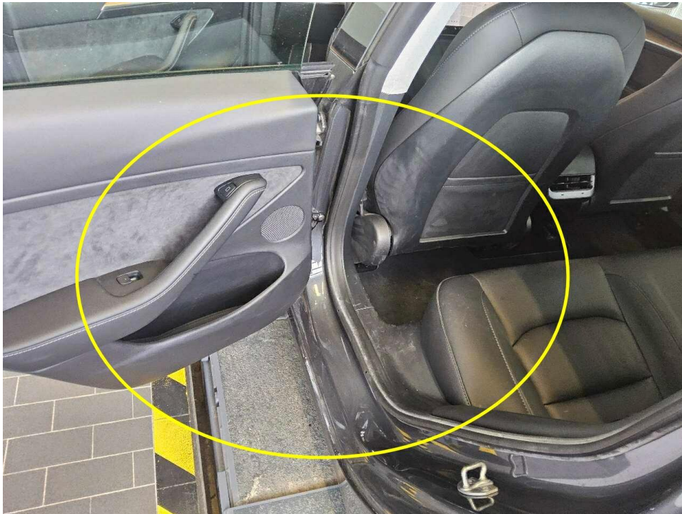
Bild 40 : Verkleidung Tür hinten links, zerkratzt, Gebrauchsspur Einstiegsblende hinten links, zerkratzt, Gebrauchsspur
