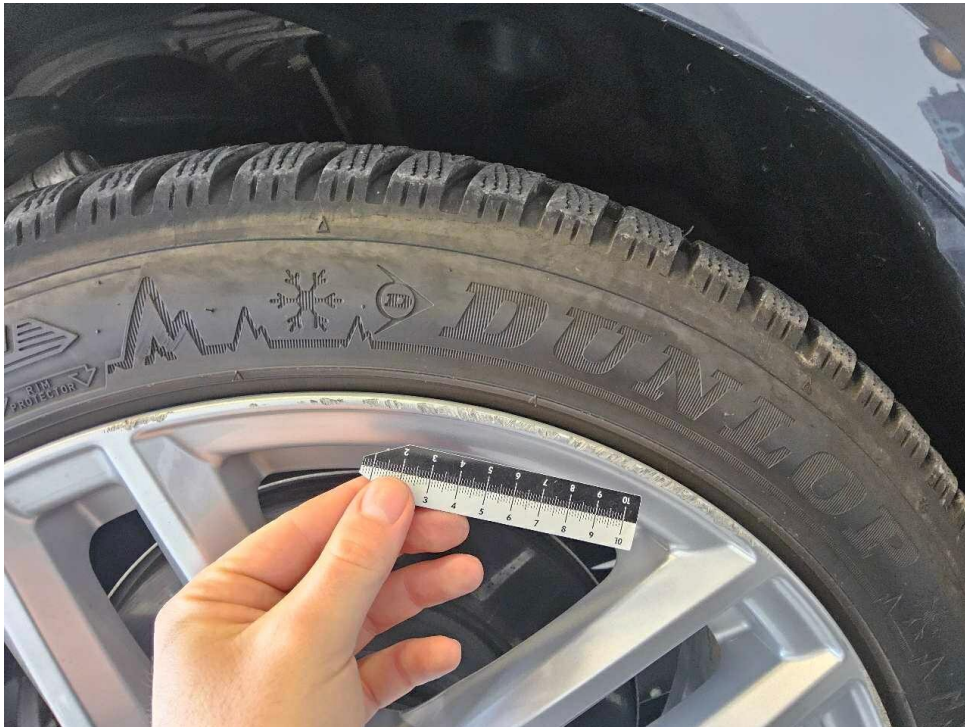
Bild 27 : Schadendetail, LM Zubehörfelge vorne rechts, verschrammt
