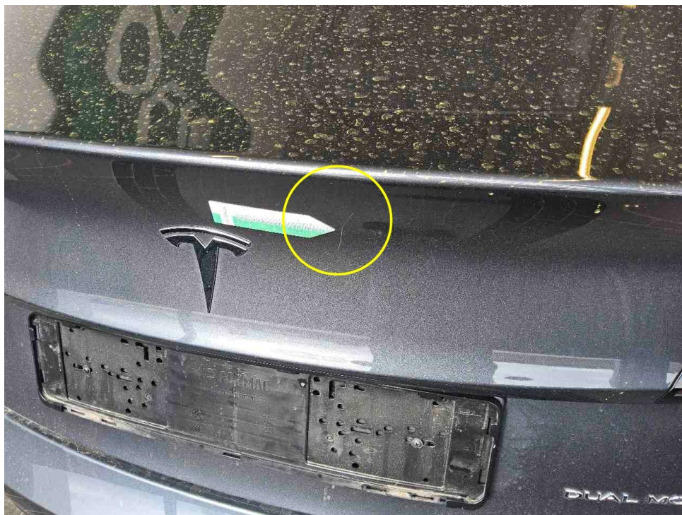
Bild 25 : Heckdeckel Lackierung, zerkratzt, smart repair
