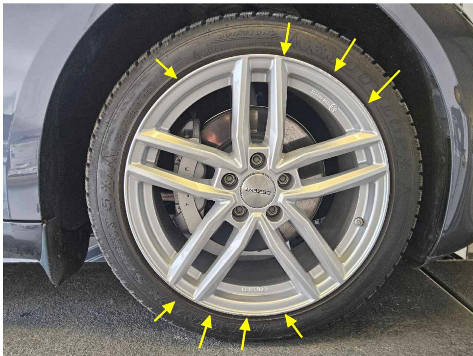
Bild 26 : Achse 1, Reifen Rechts 1 LM Zubehörfelge vorne rechts, verschrammt
