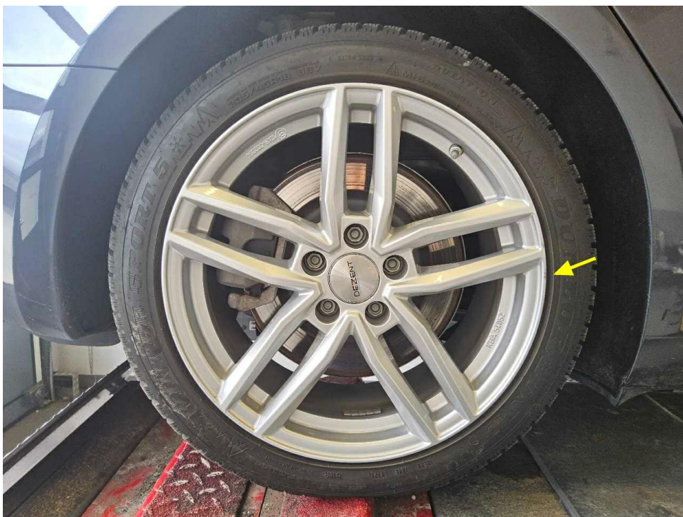
Bild 28 : Achse 2, Reifen Rechts 1 LM Zubehörfelge hinten rechts, verschrammt
