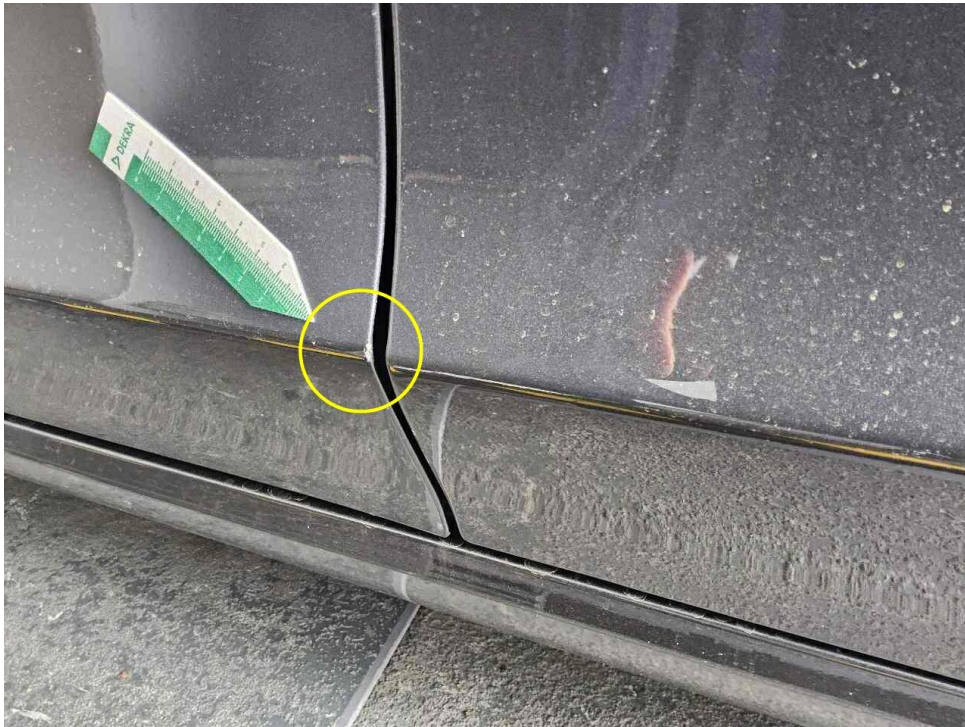
Bild 23 : Schadendetail, Tür vorne links, zerkratzt, auslegen + Polieren
