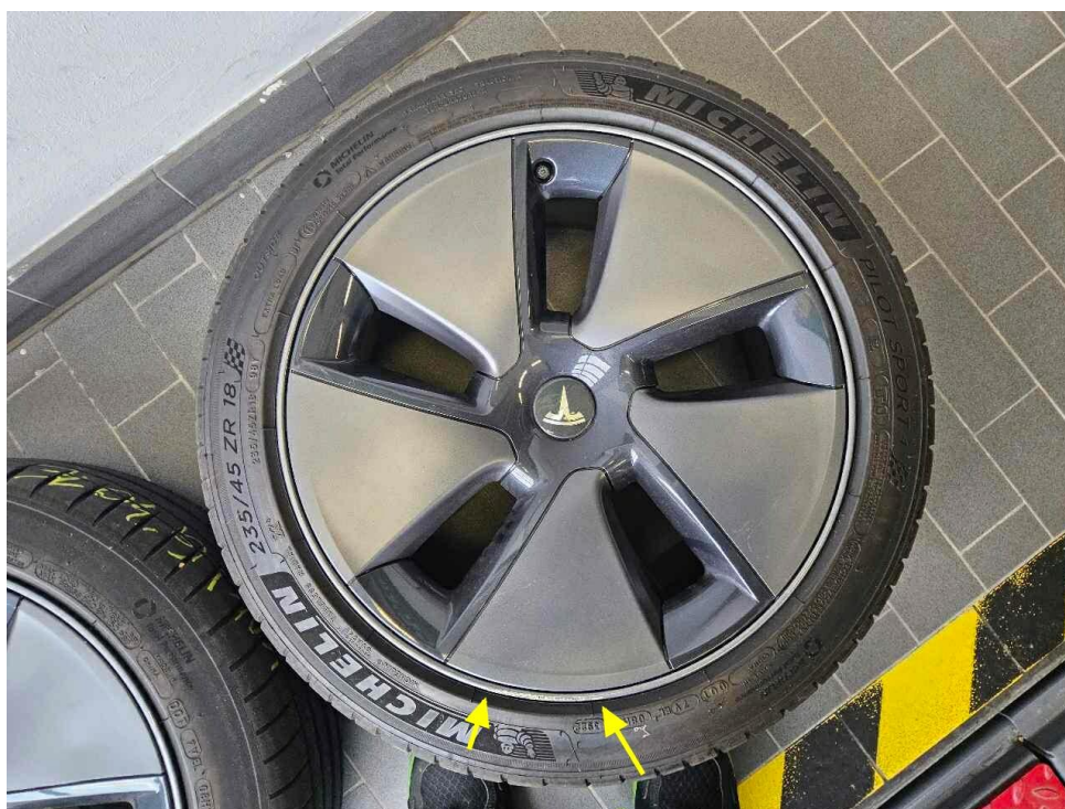
Bild 32 : Schadenübersicht, Original LM-Felge 1, verschrammt
