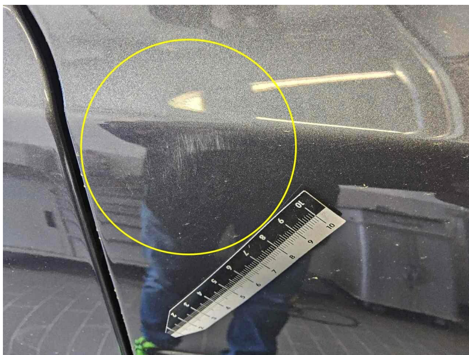
Bild 37 : Schadendetail, Kotflügel vorne rechts Lackierung, zerkratzt, Gebrauchsspur
