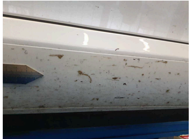
Beschädigung #7: Schweller links: Schweller - Steinschlag - lackieren
