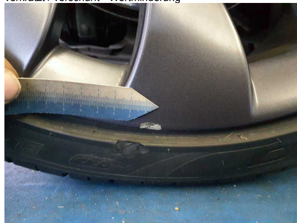
Beschädigung #2: Rad/Reifen: Leichtmetallfelge hinten rechts - verkratzt / verschürft - Wertminderung
