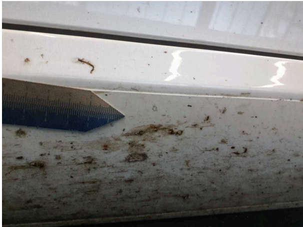
Beschädigung #7: Schweller links: Schweller - Steinschlag - lackieren
