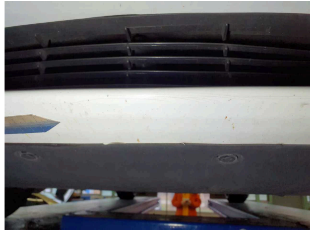
Beschädigung #9: Stossfänger vorn: Stossfänger vorn - verformt - erneuern
