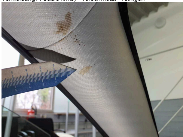
Beschädigung #1: Verkleidungen/Abdeckungen: Dachhimmel (+ Verkleidung A-Säule links) - verschmutzt - reinigen
