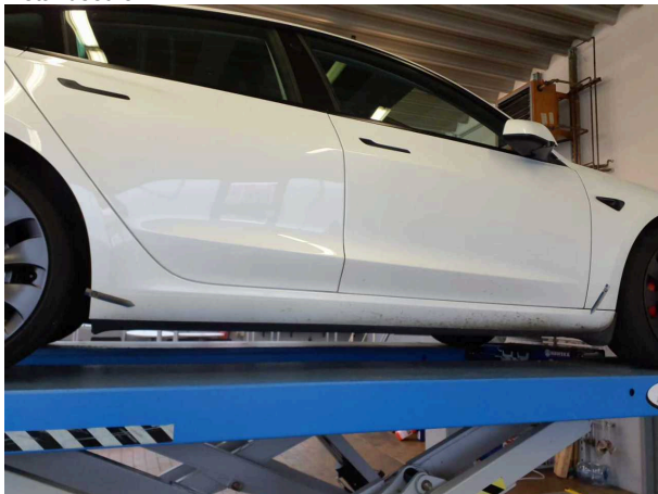
Beschädigung #6: Schweller rechts: Schweller - Steinschlag - lackieren
