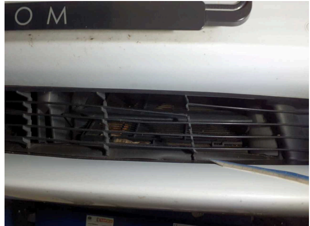
Beschädigung #3: Stossfänger vorn: Lufteinlassgitter - gebrochen / gerissen - erneuern
