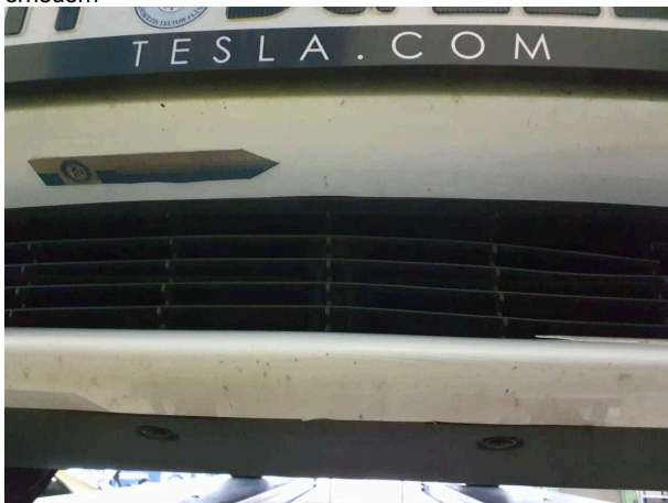
Beschädigung #9: Stossfänger vorn: Stossfänger vorn - verformt - erneuern
