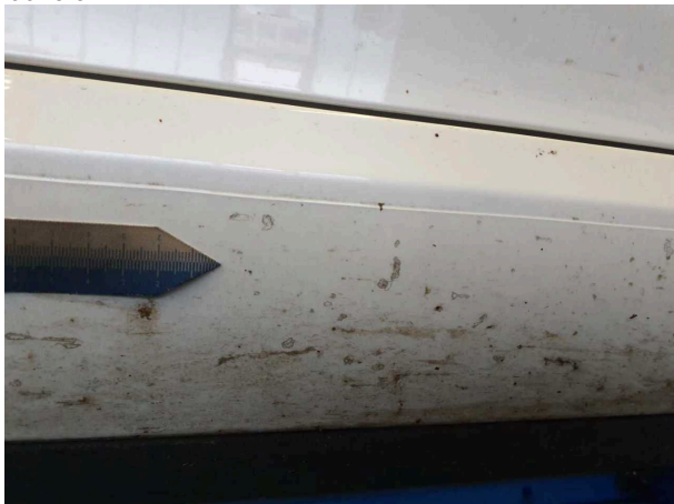
Beschädigung #6: Schweller rechts: Schweller - Steinschlag - lackieren
