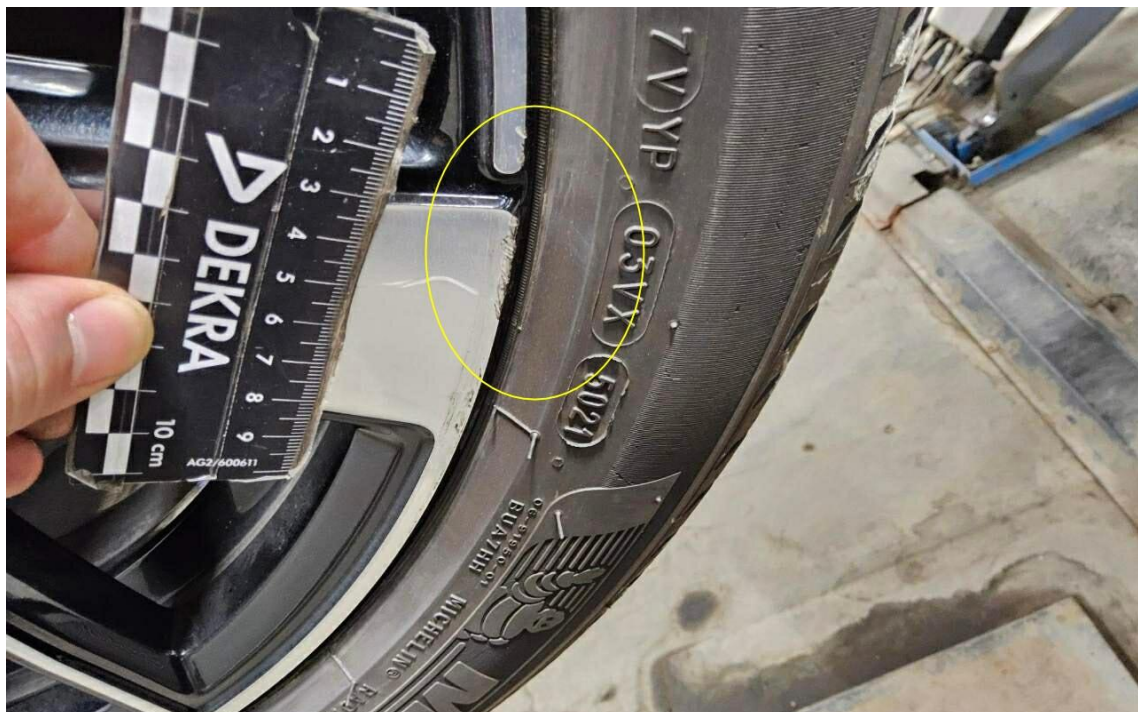
Bild 6 : Felge vorne links, verschrammt, smart repair
