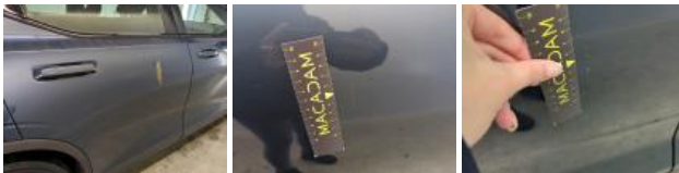
Door trim RR, Scratch(es), Replace
