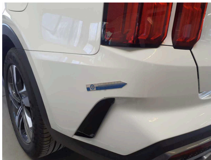
Beschädigung 3: Stossfänger hinten: Stossfänger hinten links - Kratzer - Smart Repair
