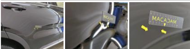
Porte AVD, Griffe(s), LI - Réparer et peindre (partiel.)
