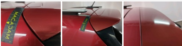
Dak, Deuk(en), Herstellen en spuiten (compleet)
