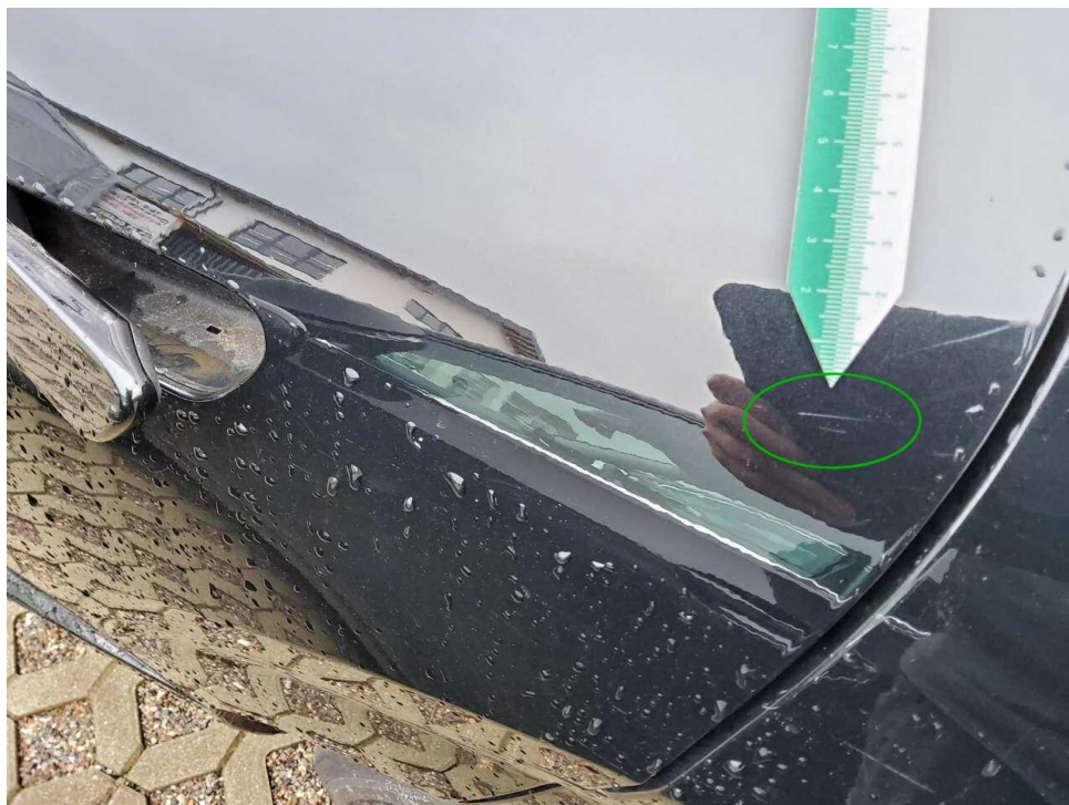
Bild 10 : Tür hinten links Lackierung, zerkratzt,
