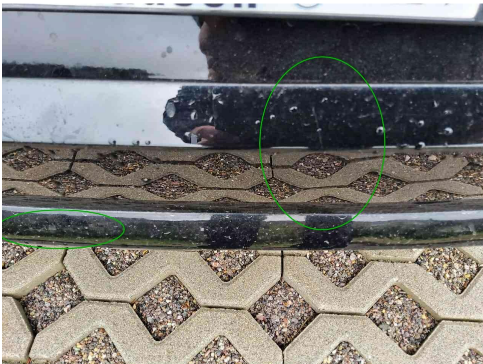
Bild 17 : Stoßfänger hinten Lackierung, zerkratzt, lackieren mit Lackaufbau
