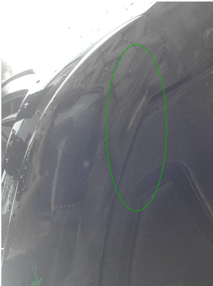
Bild 13 : Stoßfänger vorne Lackierung, zerkratzt, lackieren mit Lackaufbau
