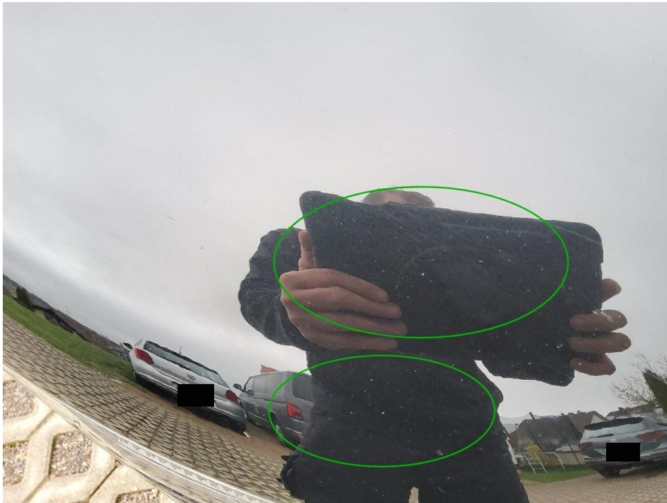
Bild 16 : Motorhaube Lackierung, viele Steinschläge, lackieren mit Lackaufbau
