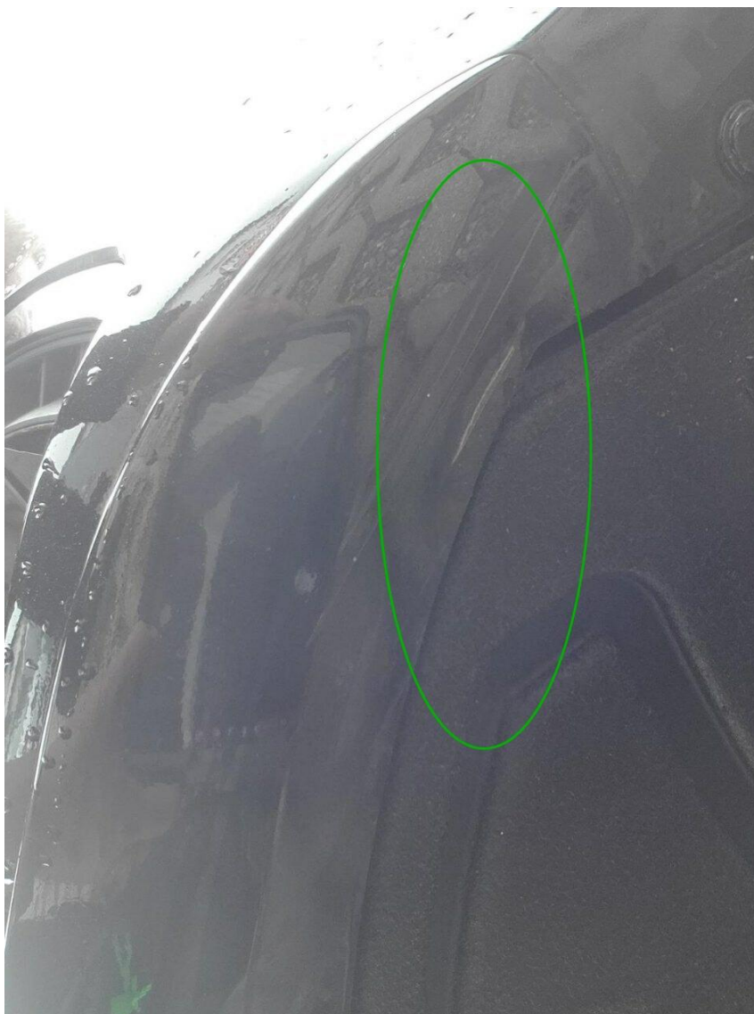
Bild 13 : Stoßfänger vorne Lackierung, zerkratzt, lackieren mit Lackaufbau
