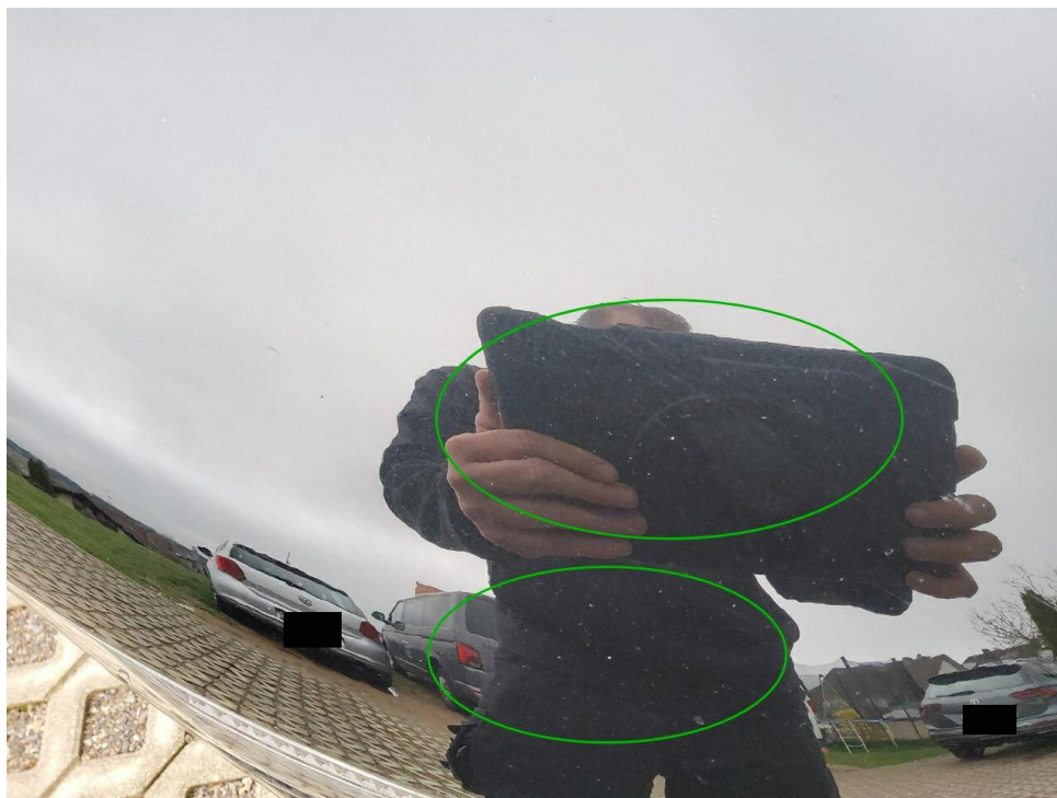
Bild 16 : Motorhaube Lackierung, viele Steinschläge, lackieren mit Lackaufbau
