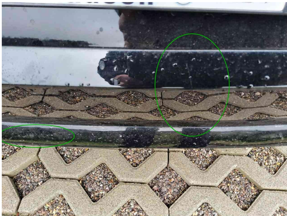
Bild 17 : Stoßfänger hinten Lackierung, zerkratzt, lackieren mit Lackaufbau
