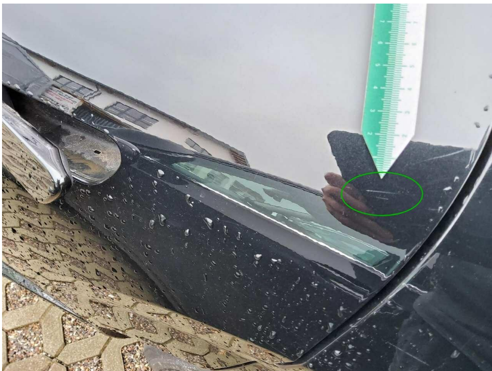
Bild 10 : Tür hinten links Lackierung, zerkratzt,
