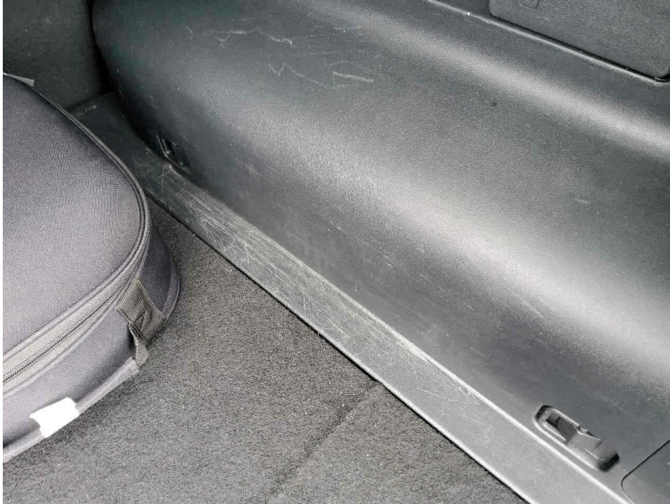
Bild 20 : Kofferraumverkleidungen diverse Kratzer,
