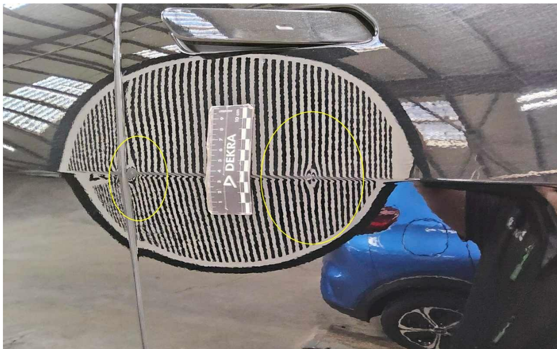
Bild 6 : Tür vorne rechts, mehrfach eingedellt, smart repair
