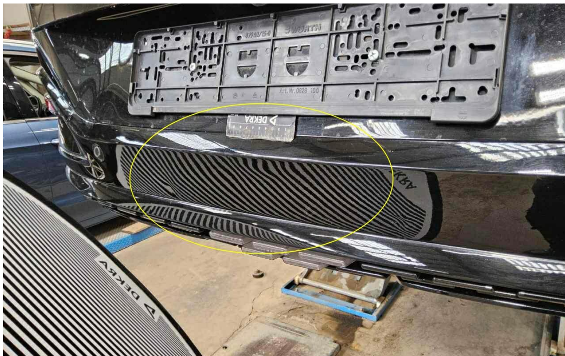
Bild 9 : Stoßfänger hinten, verformt, instandsetzen und lackieren mit Lackaufbau
