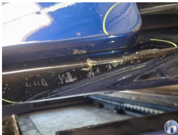
3. Frontspoiler Beschädigt - Smart Repair
