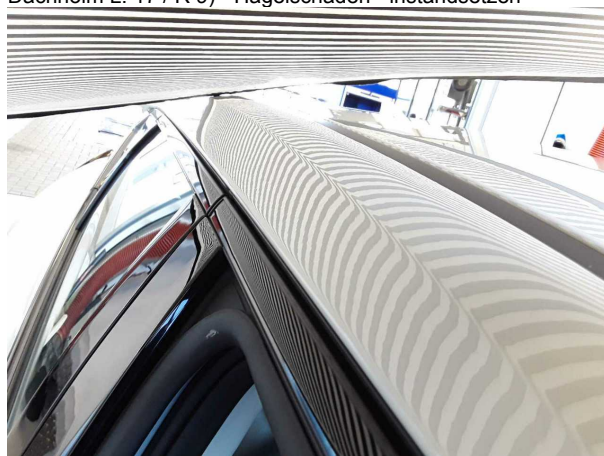
Beschädigung #1: Karosserie: Karosserie (Dellen: Dach 31, Dachholm L. 17 / R 9) - Hagelschaden - instandsetzen
