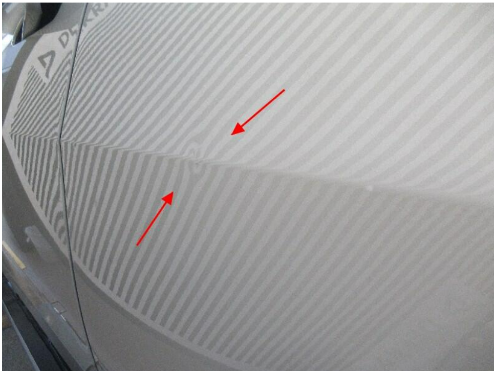
Bild 20 : Tür hinten links, eingedellt, drücken
