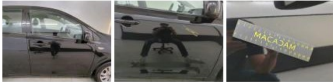
Handgreep buiten V R, Kras(sen), Herstellen en spuiten (compleet)
