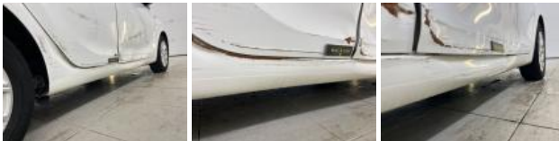
Deurframe A R, Vervormd / Geforceerd, Herstellen en spuiten (gedeeltelijk)
